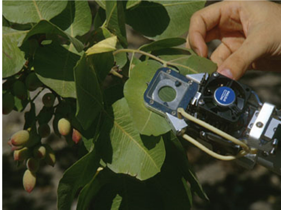
Fig. 5.4.1 - Misurazione degli scambi gassosi della foglia con CIRAS-2.
