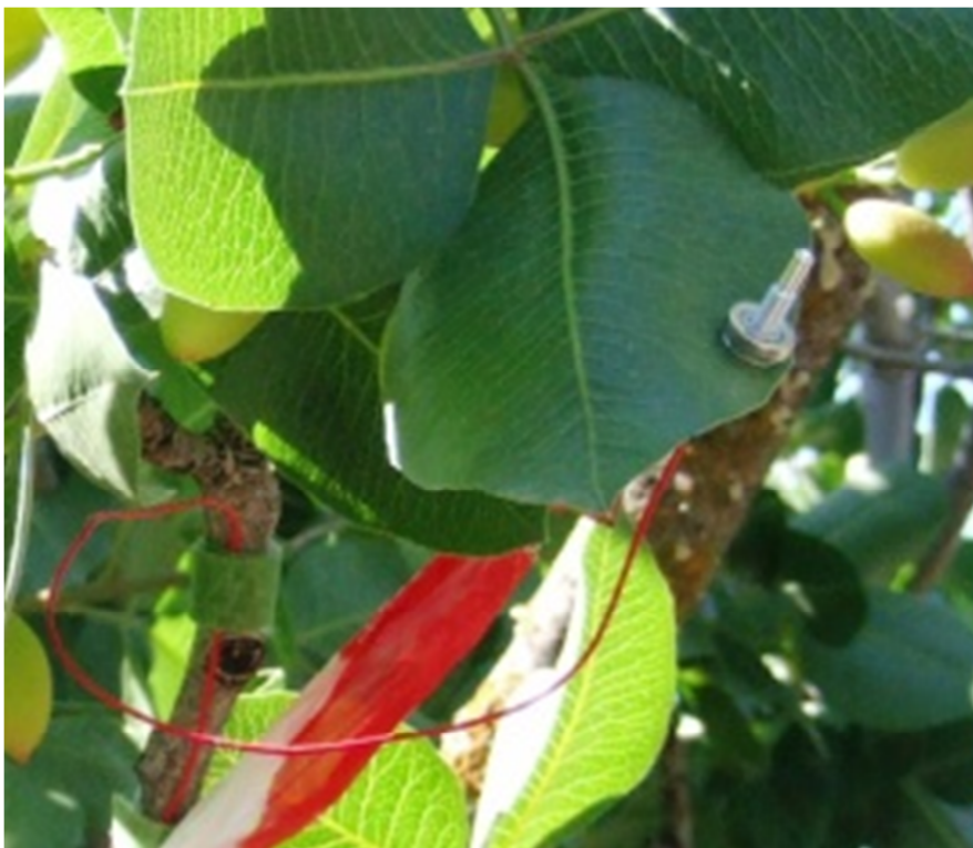
Fig. 5.3.4 – Particolare di una sonda ZIM su una foglia.
