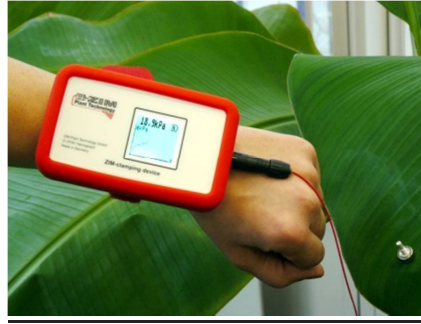
Fig. 5.3.3 - Regolazione della pressione in uscita durante il posizionamento degli ZIM.
