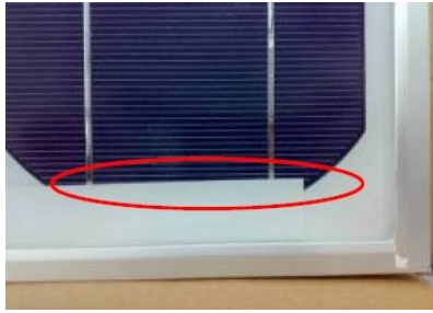
Figura 31 Parziale copertura di una cella
