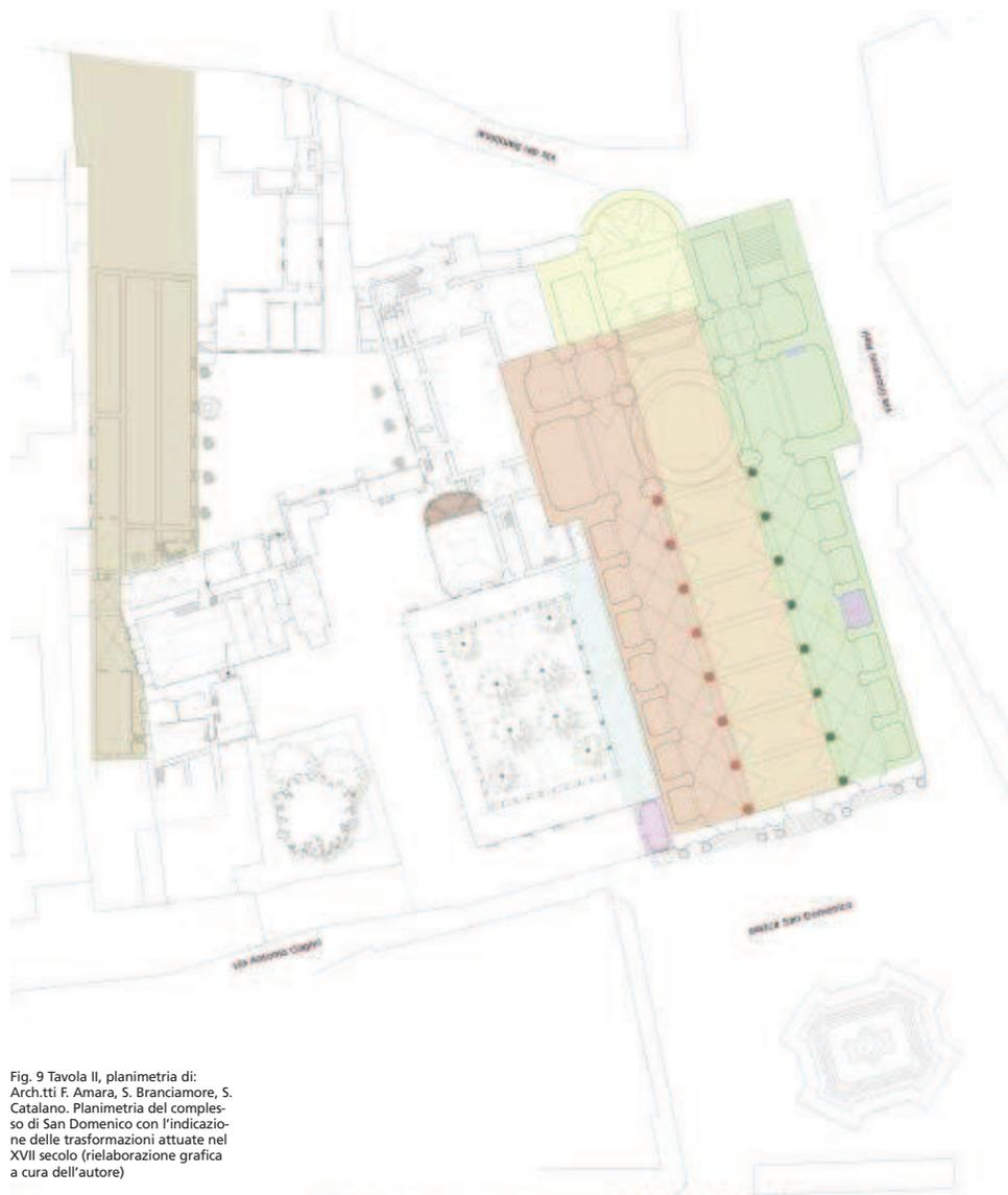
Fig. 9 Tavola II, planimetria di: Arch.tti F. Amara, S. Branciamore, S. Catalano. Planimetria del complesso di San Domenico con l'indicazione delle trasformazioni attuate nel XVII secolo (rielaborazione grafica a cura dell'autore)
