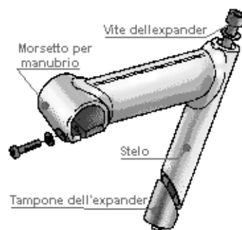
Figura 7.3: Elementi costitutivi del manubrio con attacco tradizionale (tratta da http://www.cicloturismo-mtb.com ).
