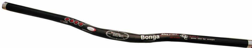
Figura 7.9 Esempio di manubrio per mountain bike; modello Bonga della Gass , realizzato in alluminio 7075.
