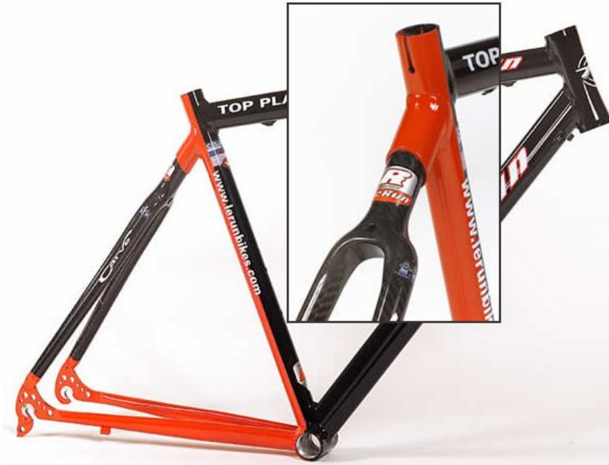
Figura 5.11 notare il semplice montaggio e fissaggio dei foderi pendenti in carbonio di questo telaio (tratta da www.lerunbikes.com ).
