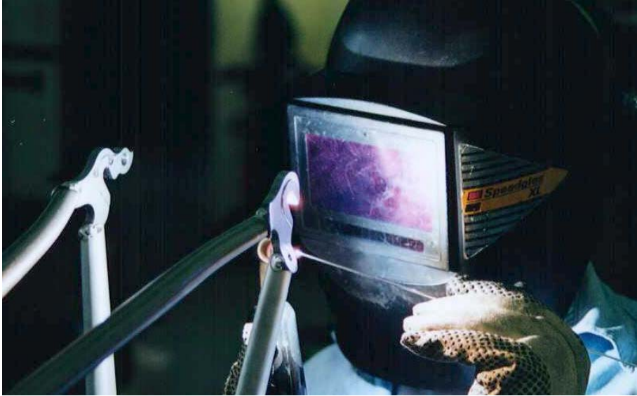
Figura 23.5 Saldatura TIG dei forcellini al telaio (tratta da http://www.bicitalia.com )
