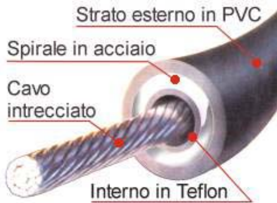
Figura 10.3 Schema struttura delle guaine (tratta da http://www.cicloturismo-mtb.com ).
