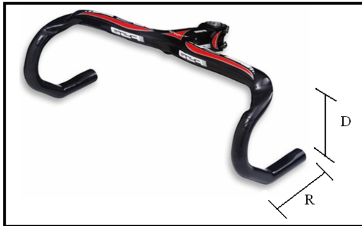
Figura 7.8: Misurazione del reach e del drop dello sterzo.
