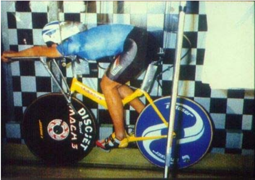
Figura 15.2 studio in galleria del vento (tratta da http://scienzadellosport.coni.it ).
