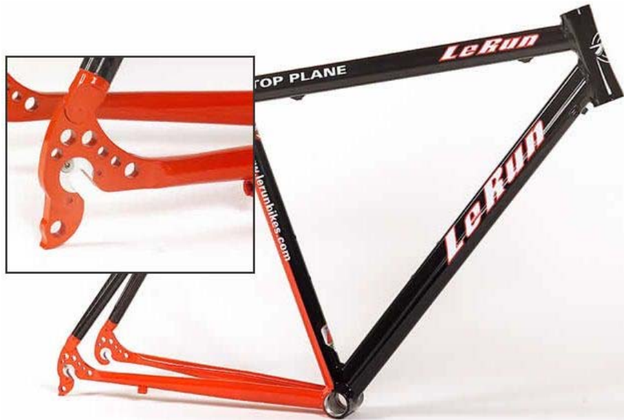
Figura 5.12 Particolare dei forcellini del telaio precedente (tratta da www.lerunbikes.com ).
