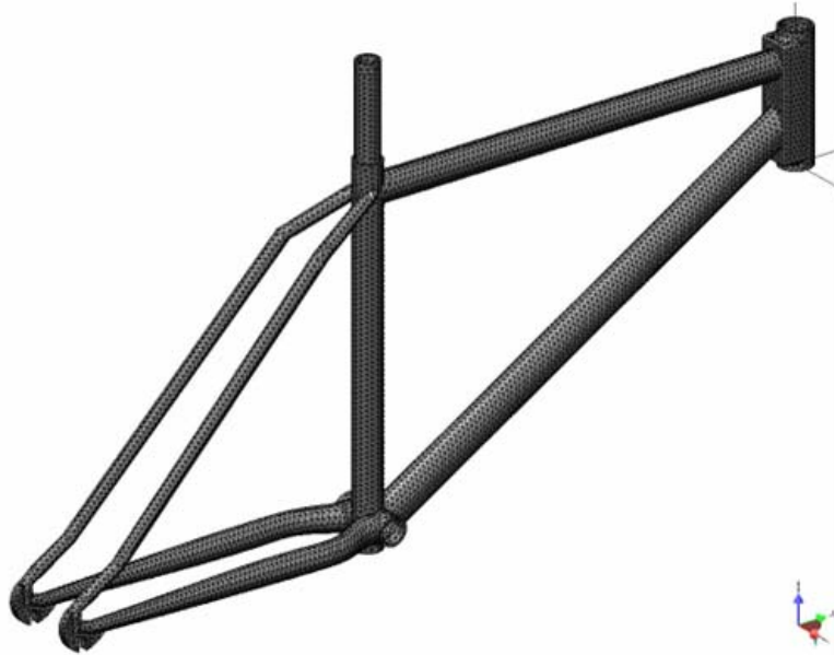
Figura 21.1 Discretizzazione del telaio in elementi triangolari.
