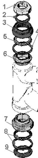
Figura 7.2 Esploso della serie sterzo (tratta da http://www.cicloturismo-mtb.com ).
