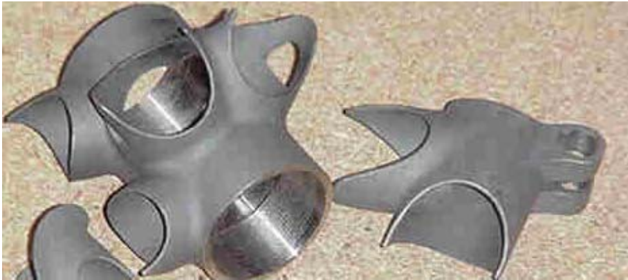
Figura 23.1 Giunzioni adoperate in processi di saldobrasatura (tratta da http://www.bicyclespecialtiesonline.com )
