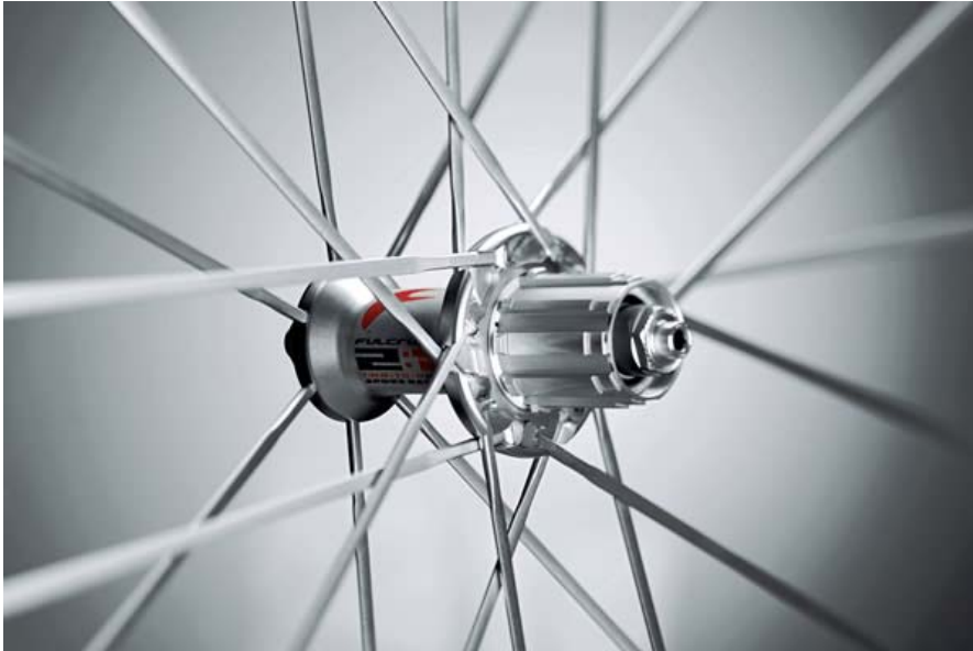
Figura 13.12 Particolare dei raggi fissati sul mozzo del modello Racing della Fulcrum .
