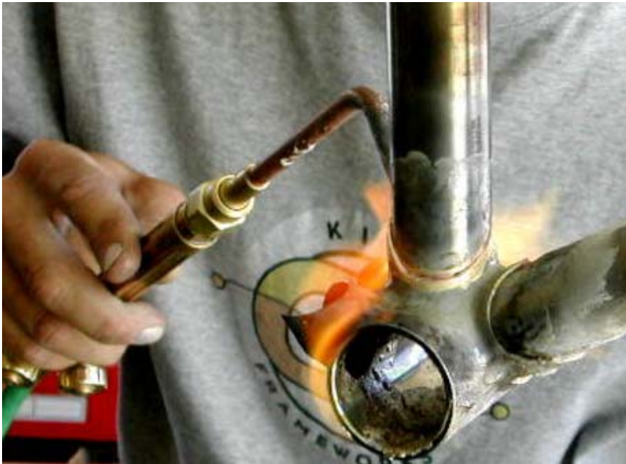
Figura 23.2 “Brazing the bottom racket” Si notano i due tubi inseriti nella giunzione ed il materiale di apporto che li unisce (tratta da http://www.kirkframeworks.com ).
