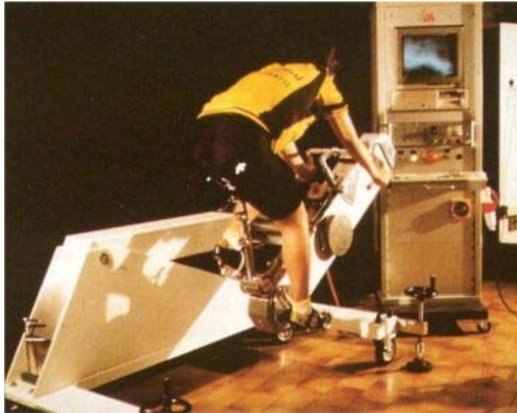
Figura 11.8 Studio isocinetico (ERGOMETRO "DALMEX - Dal Monte") (tratta da http://scienzadellosport.coni.it ).
