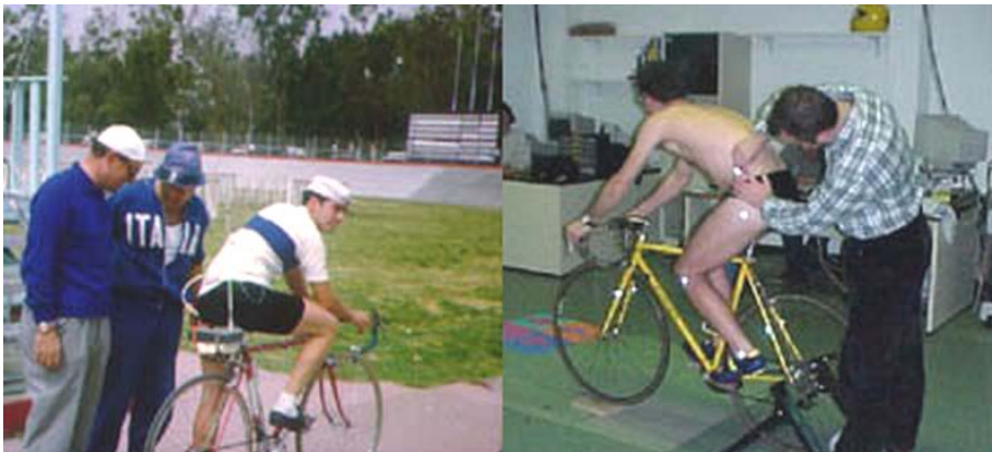
Figura 11.7 La foto di sinistra mostra i test di telemetria svolti in pista; quella di destra l'analisi biomeccanica con telecamere. E' possibile notare i marker rifrangenti applicati sul ciclista. (tratta da http://scienzadello sport.coni.it ).
