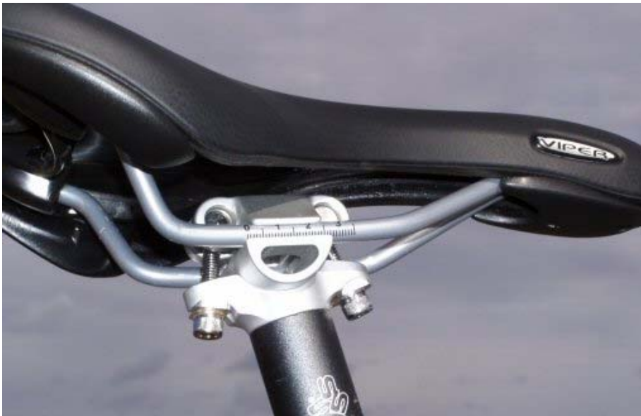
Figura 9.4 Notare il sistema di regolazione millimetrico dell'arretramento e le due viti di regolazione.
