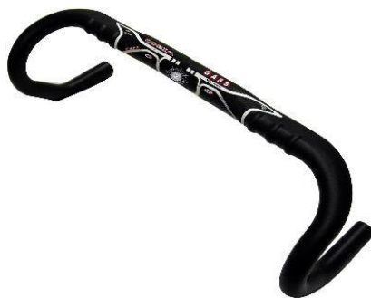
Figura 7.10 Esempio di manubrio per biciclette da competizione; modello Cobia della Gass , realizzato in alluminio 6061.
