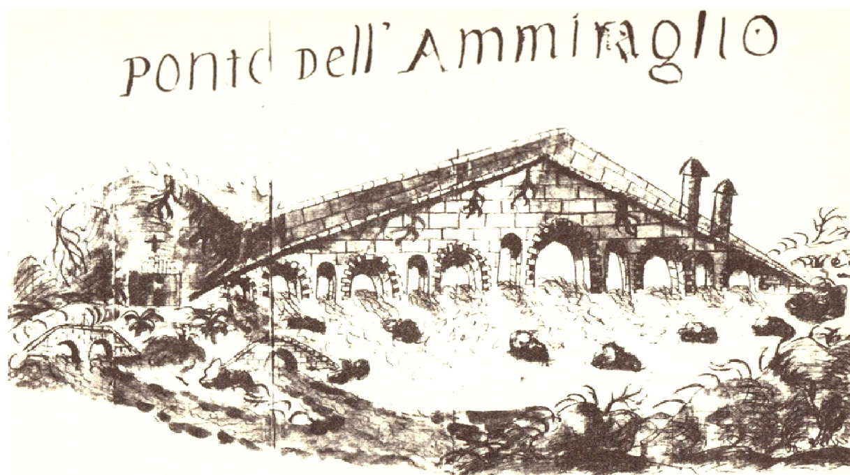
Figura 7: Schizzo riportato dal Villabianca in cui è rappresentato schematicamente l'intero sistema di passaggio del fiume: 12 campate del ponte normanno, 2 del ponte piccolo sul ramo laterale, 1 campata del nuovo ponticello realizzato da Pietro Raineri su impulso del marchese Natale.
