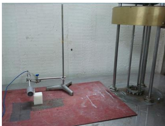
Fig. 1 – Posizionamento della camera di ionizzazione all'interno della camera di irraggiamento
