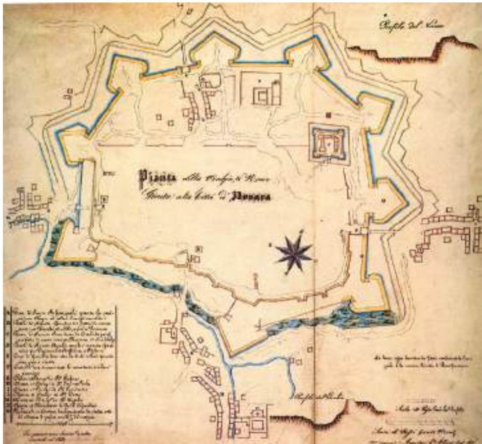
Fig. 1 | Moment of transition between the fortified system of the medieval city and the new ring wall with bastions (source: Alberti, A., 1610, Pianta della Vecchia e Nuova Gionta alla città di Novara , Novara, an 1852 copy by the surveyor Nasi, G., Archivio di Stato, Disegni, L/1; Archivio Storico Novara).
