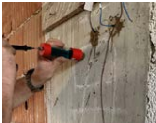
> Applicazione del protocollo sperimentale TEM basato su sensori per la rilevazione di pH e concentrazione di cloruri a Terrasini e presso la sede della CITET a Tunisi (foto F. Anania, settembre 2023; M.L. Germanà, settembre 2023)
