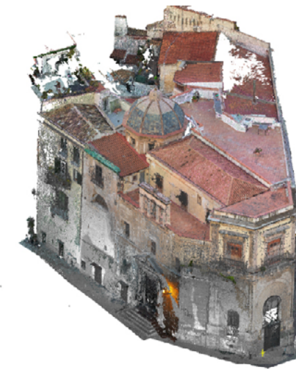
Fig. 22 Immagini delle point cloud ottenute dal rilievo SfM da drone delle chiese di Santa Maria di Porto Salvo e di San Giovanni dei napoletani.
