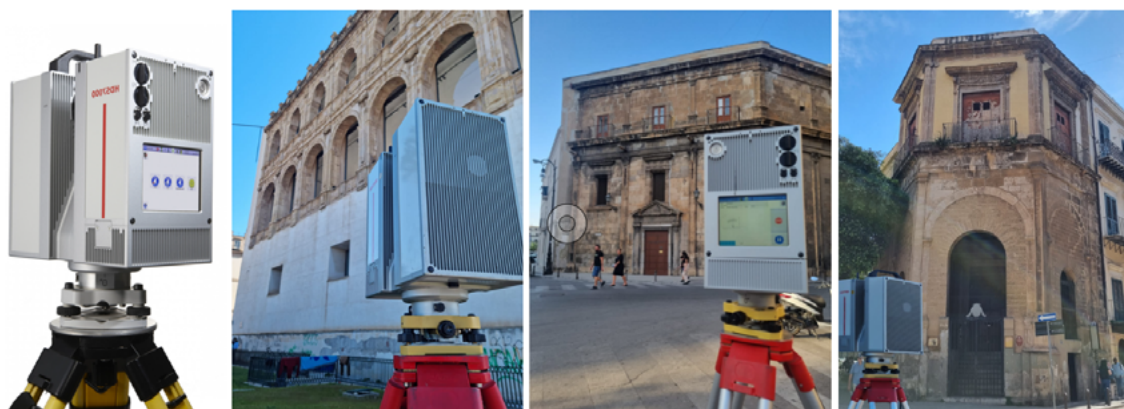
Fig. 8 Da sinistra: modello Laser scanner LEICA HDS 7000 ; Acquisizione dati e punti di stazionamento durante le fasi delle campagne di rilievo.
