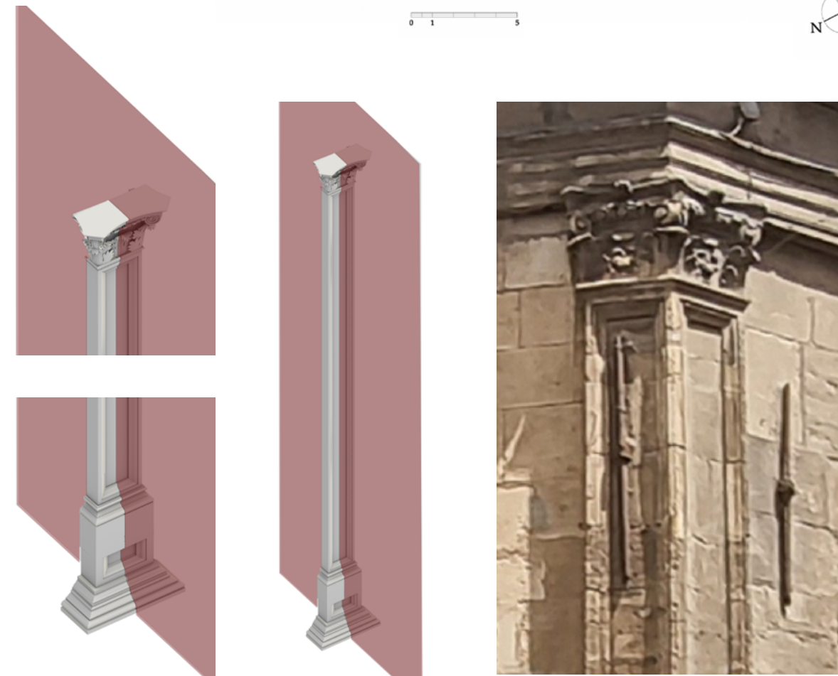
Fig. 28 Costruzione e studio geometrico di dettaglio delle paraste interne.
