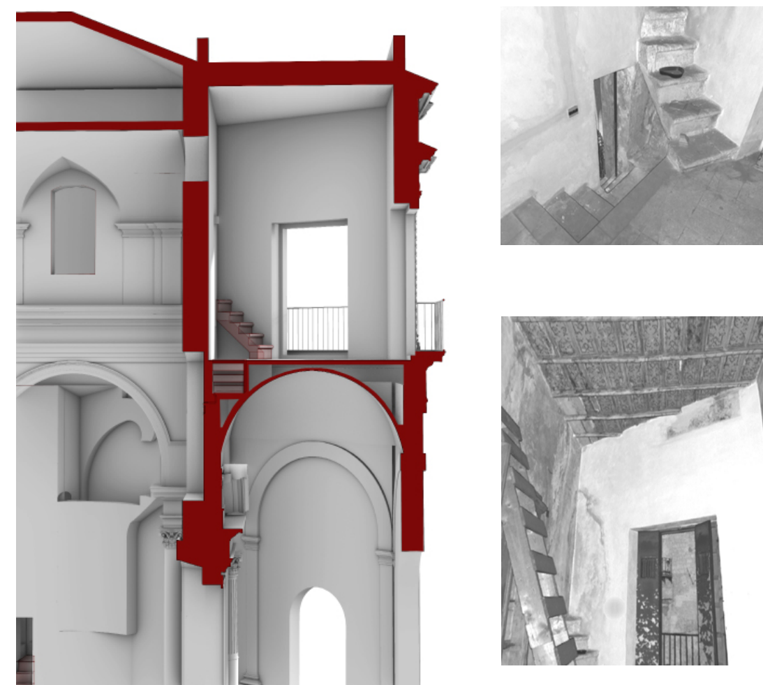
Fig. 14 Modello di rilievo: dettaglio dell'accomodamento delle scalette nell'intercapedine esistente tra la l'estradosso della volta di copertura del portico e il solaio della quota superiore.
