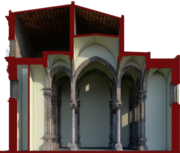
Fig. 48 Chiesa di Santa Maria di Portosalvo a Palermo. Modello ricostruttivo; sezione AA longitudinale lungo la navata laterale nord.
