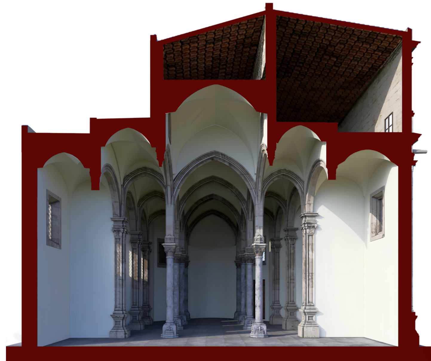
Fig. 59 Chiesa di Santa Maria di Portosalvo a Palermo. Modello ricostruttivo; spaccato prospettico con a vista il sistema delle colonne e degli archi acuti (a destra)
