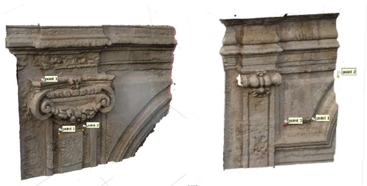
Fig. 26 Modelli di rilievo mesh di entrambi i capitelli del loggiato di San Bartolomeo. Sono visibili anche i target applicati per l'orientamento e scalatura dei modelli rispetto la point cloud generale del loggiato.
