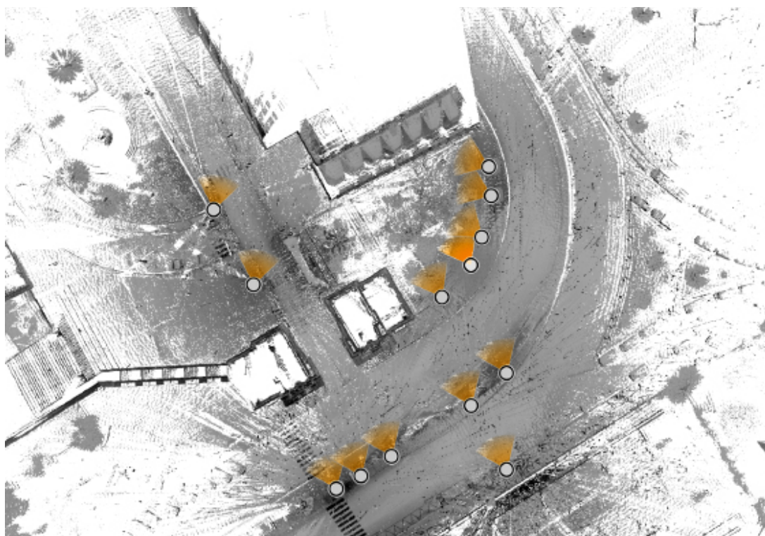
Fig. 9 Immagine della point cloud e dei punti di stazionamento dell'area del Loggiato di San Bartolomeo dopo la pulitura su Recap e dopo la fase di sampling su Cloud Compare.
