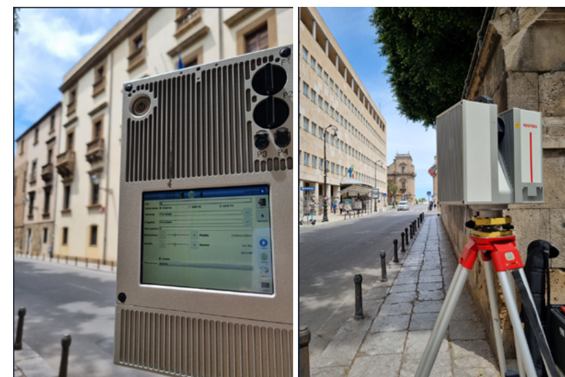
Fig. 1 Foto delle fasi di rilievo con laser scanner LEICA HDS 7000.
