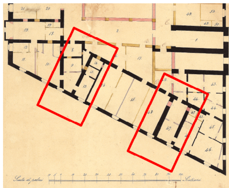
Fig. 11 Incongruenze grafiche tra le tracce dei setti murari e l'indicazione delle aperture di prospetto presenti all'interno del disegno d'archivio, riferimento 6A n. 447, corrispondente qui alla Carta 15 della sezione Disegni d'Archivio - rilievi di cantiere.
