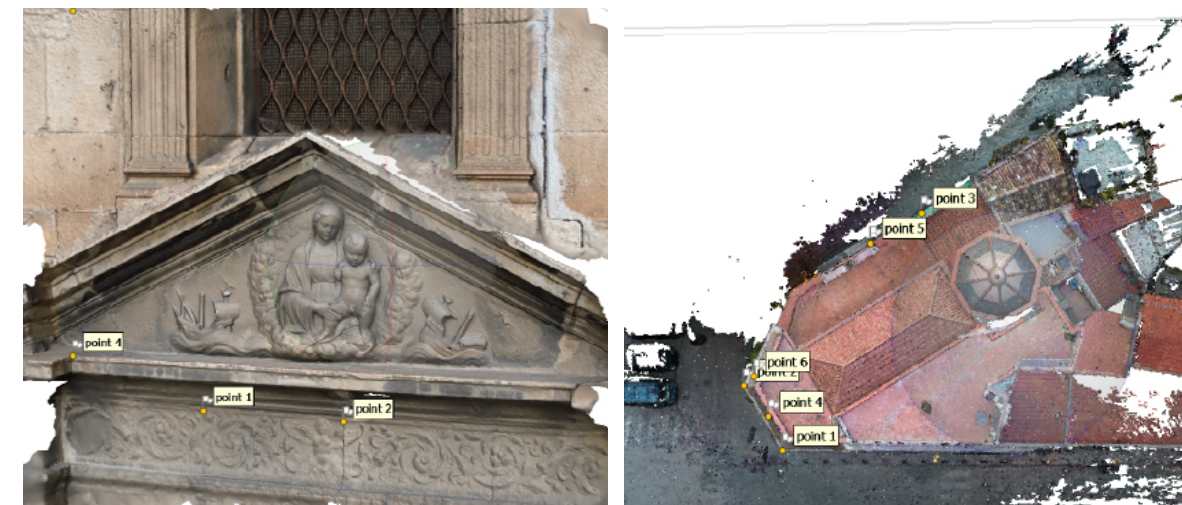
Fig. 27 Modelli di rilievo mesh del bassorilievo sul timpano di Santa Maria di Portosalvo; a vista i target per orientare e scalare il modello (a sinistra) rispetto la point cloud generale (a destra).
