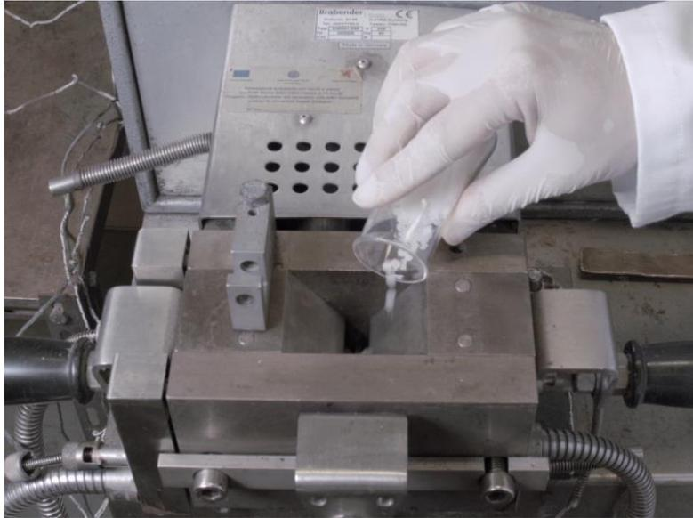
*Figura 48 miscelatore interno Plasticorder, Brabender*
