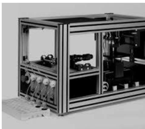
Figura 40 FTA 1000 apparecchiatura per test di bagnabilità (WCA) FTA 1000 First Ten Ångströms
