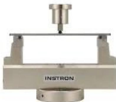
*Figura 38 dinamometro INSTRON 3365 set-up per prova di flessione a tre punti*
