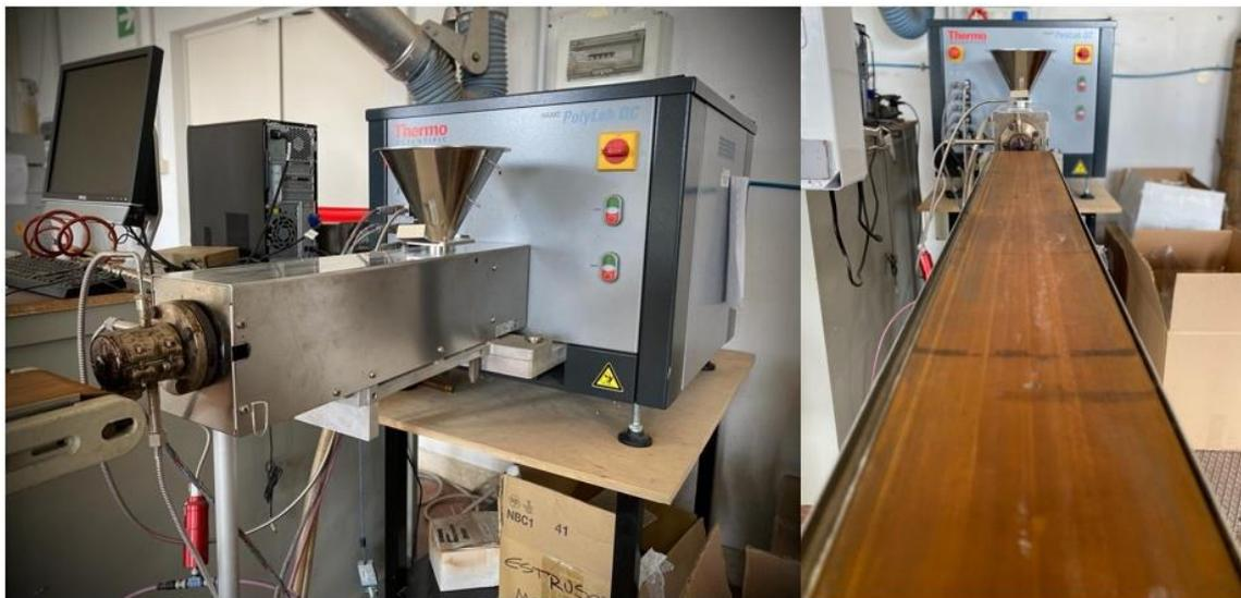
*Figura 50 a sinistra) estrusore monovite HAAKE™ Poly Lab™ QC della Thermo Scientific; a destra) tappeto rotante per regolare il diametro dei filamenti estrusi*
