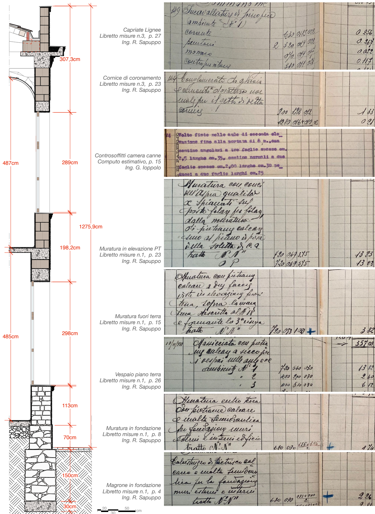
Fig. 35 - A sinistra, una sezione tecnologica della scuola F. Orestano; a destra la documentazione d'archivio usata come riferimento per ricostruire la stratigrafia senza indagini invasive [ASPa, Fondo L.L.P.P., serie (2-3-1), 1936, Vol. 3], disegni a cura dell'autore.
