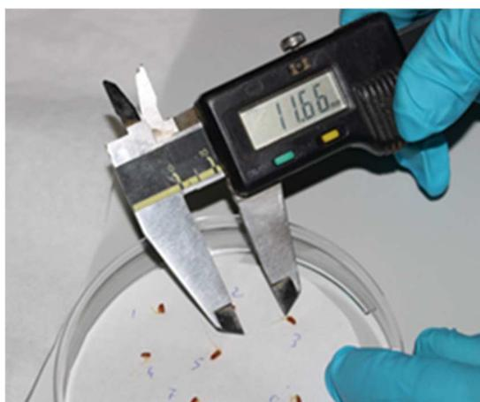
**Figura 3. 11. Misura lunghezza delle radici con calibro digitale**
