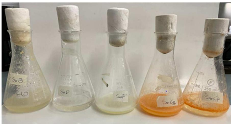
**Figura 3. 2. Colture batteriche degli isolati *Gordonia* SoCg, SoCp, *Nocardia* SoB e *Rhodococcus* SoD, SoF inoculate in microcosmo dopo 120 giorni di sperimentazione**
