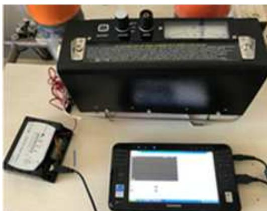
**Figura 3. 17. GASTEC ® MK III, rilevatore a ionizzazione di fiamma (FID) portatile**
