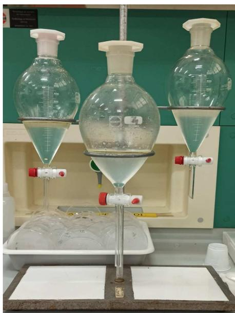
**Figura 3. 6. Separazione della fase organica in imbuto separatore**
