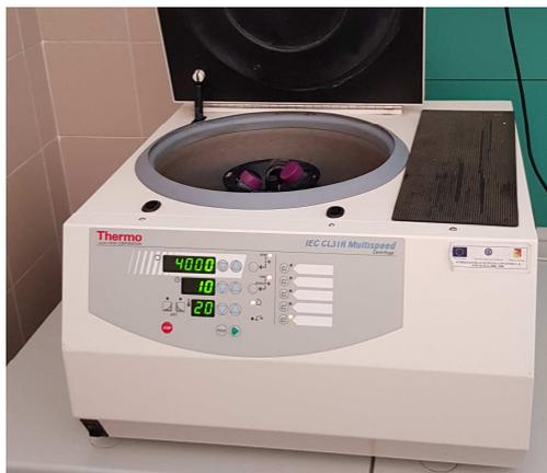
**Figura 3. 5. Separazione solido-liquido mediante centrifugazione**
