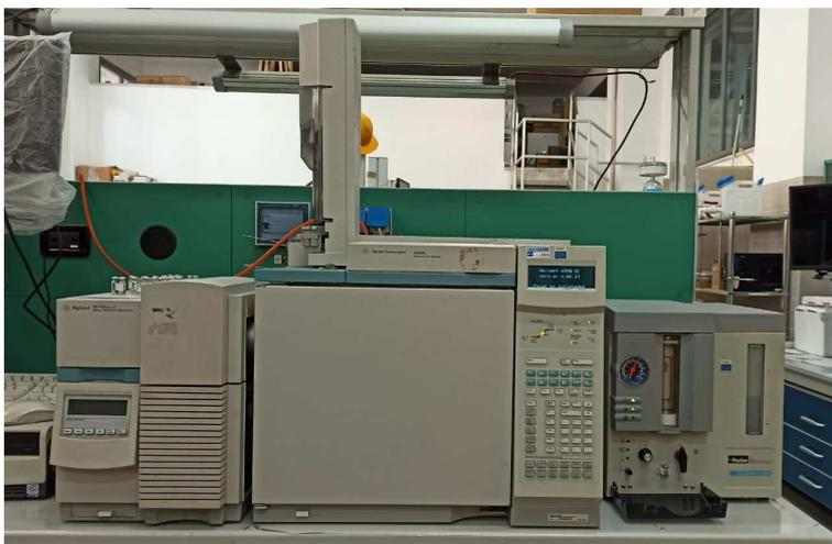
**Figura 3. 9. Gascromatografo con rilevatore FID**
