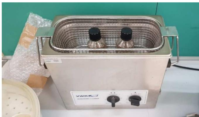
**Figura 3. 4. Estrazione della fase organica in bagno a ultrasuoni**
