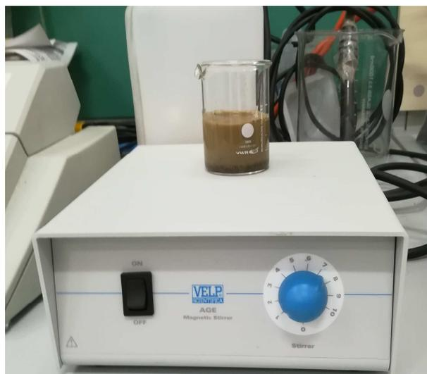
**Figura 3. 12. Fase di agitazione della sospensione suolo-acqua**
