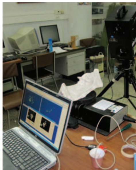
Fig. 5: Acquisizione della forma geometrica di un modello in gesso riprodotto una porzione d'angolo di un capitello composito. Applicazione della tecnica di rilevamento laser scanner a triangolazione.
