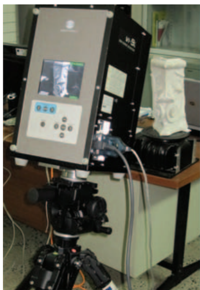
Fig. 5: Acquisizione della forma geometrica di un modello in gesso riprodotto una porzione d'angolo di un capitello composito. Applicazione della tecnica di rilevamento laser scanner a triangolazione.
