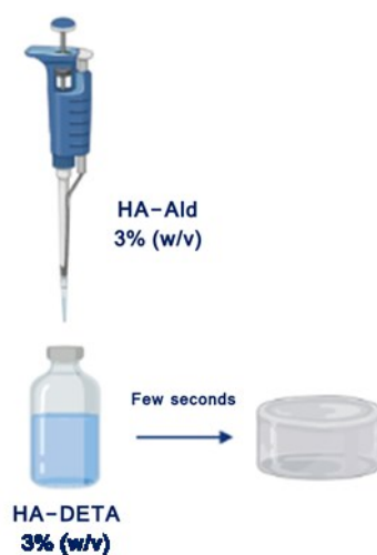
Figura 71. Illustrazione schematica della preparazione degli idrogeli HA-Ald/HA-DETA
