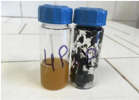
**Figura 58** - Frazioni liquida (a sinistra) e solida (a destra) ottenute dalle prove a  $T=420\text{ }^{\circ}\text{C}$  e  $P=1\text{ bar}$ .
