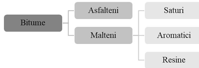
**Figura 34** - Composizione chimica del bitume.
