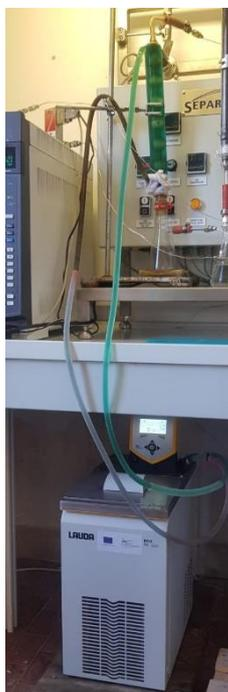
*Figura 22 - Dettaglio del sistema di raffreddamento.*
