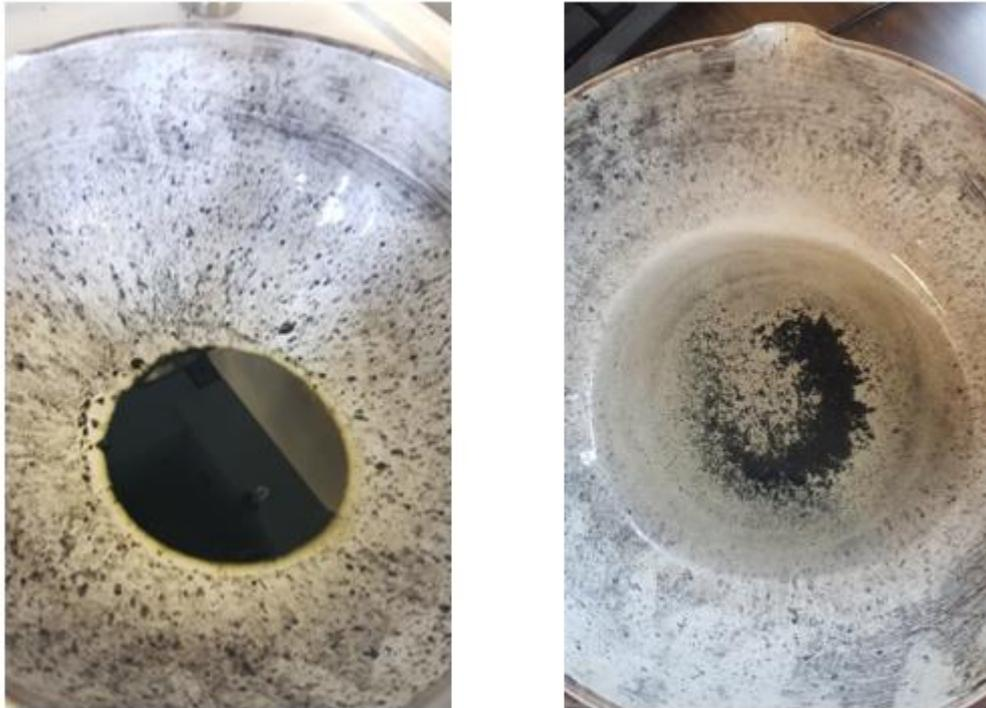
**Figura 40** - Confronto tra il solvente raccolto durante la fase di pulizia del reattore dopo la pirolisi del bitume effettuata alla temperatura di 450 °C (sinistra) e di 550 °C (destra).
