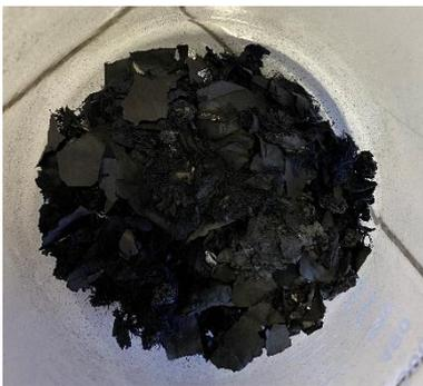
**Figura 78** - Solido residuo raccolto dalla prova di pirolisi di CDR a 450 °C.
