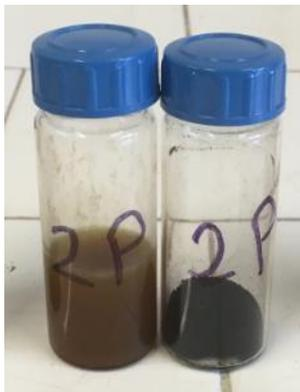
**Figura 62** - Frazioni liquida (a sinistra) e solida (a destra) ottenute dalle prove a  $T=450$  °C e  $P=1$  bar.
