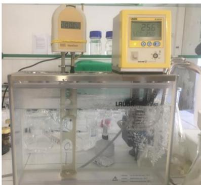
*Figura 31 - Sistema per la misura della viscosità Viscoclock plus.*
