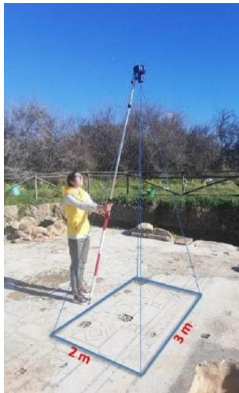
**Fig. 50 – Esecuzione del rilievo fotogrammetrico con asta telescopica e indicazione a terra delle dimensioni delle immagini**
