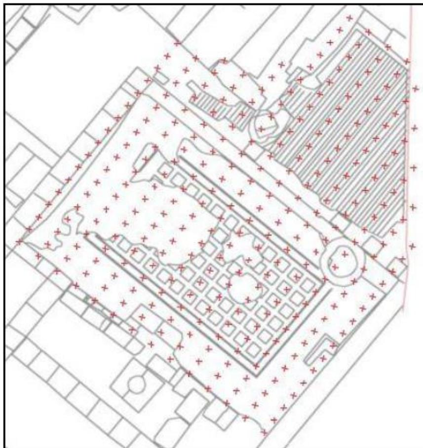
**Fig. 48 – Progettazione del rilievo fotogrammetrico in pianta con schema di ripresa dei fotogrammi nell'area dei pavimenti a mosaico e in *opus spicatum***
