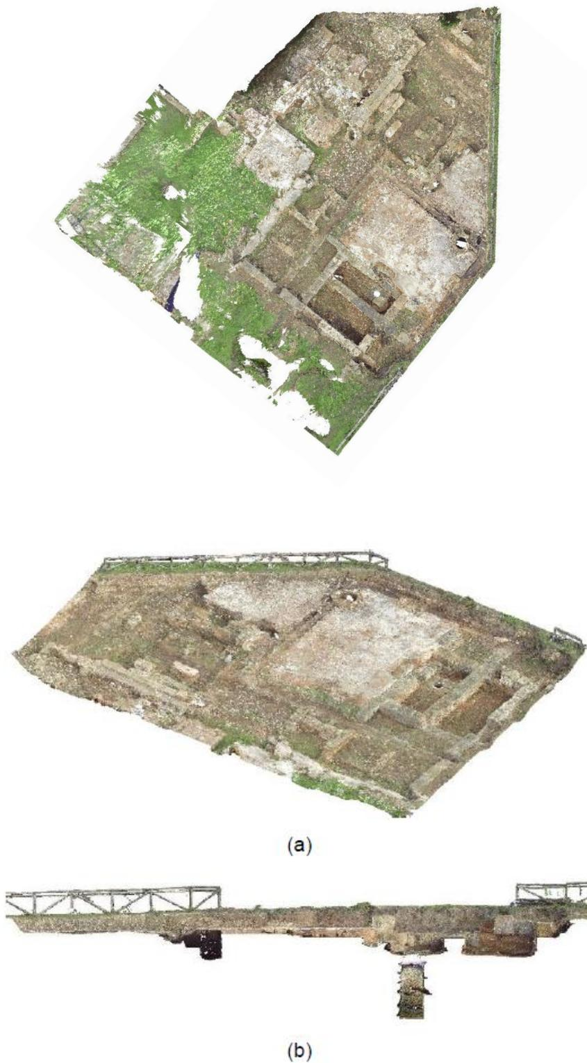
**Fig. 45 - Area sacra dell'insula III. Area sacra dell'insula III. Dall'alto, nuvola di punti complessiva di 143 mln di punti da rilievo laser-scanner. In basso, nuvola di punti ricamionata (69 mln) comprendente l'area dei C.F. "A-C" in vista assonometrica da SO (a) e sezione con evidenza delle strutture in negativo (b)**
