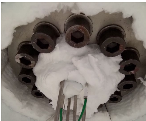
Figura 88 Dettagli della fascia riscaldante e dell'applicazione del materiale isolante
