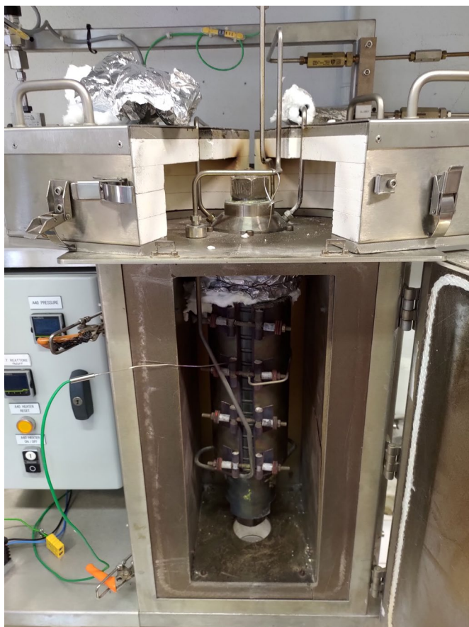
Figura 44 Interno e sezione trasversale del reattore Separex Autoclave HPV200
