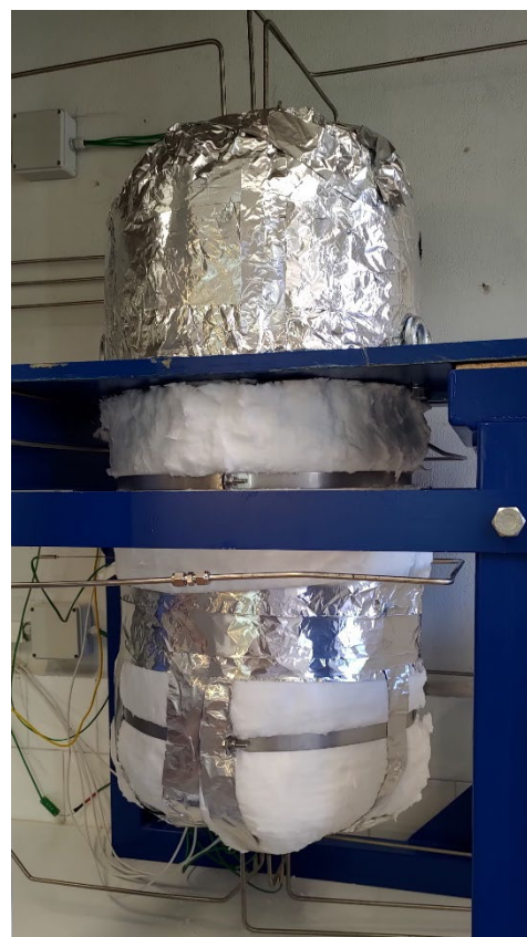
Figura 88 Dettagli della fascia riscaldante e dell'applicazione del materiale isolante
