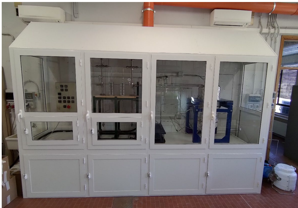
Figura 80 Cabina aspirata per l'impianto pilota combinato SCWGcO
