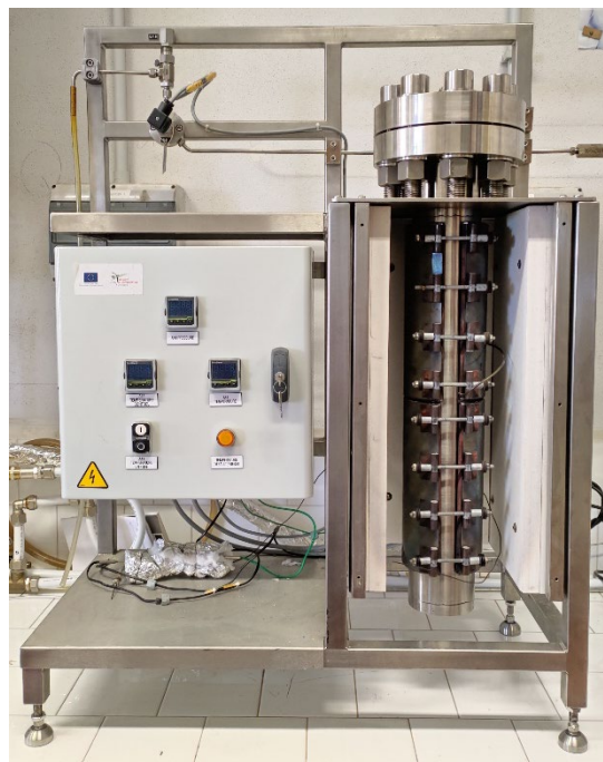
Figura 71 Fasi di installazione del nuovo reattore nel sistema di controllo del vecchio reattore HPV500
