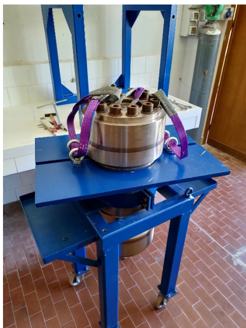
Figura 87 Posizionamento del reattore combinato sulla struttura di supporto
