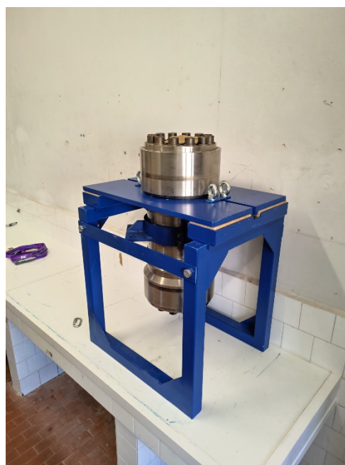
Figura 87 Posizionamento del reattore combinato sulla struttura di supporto
