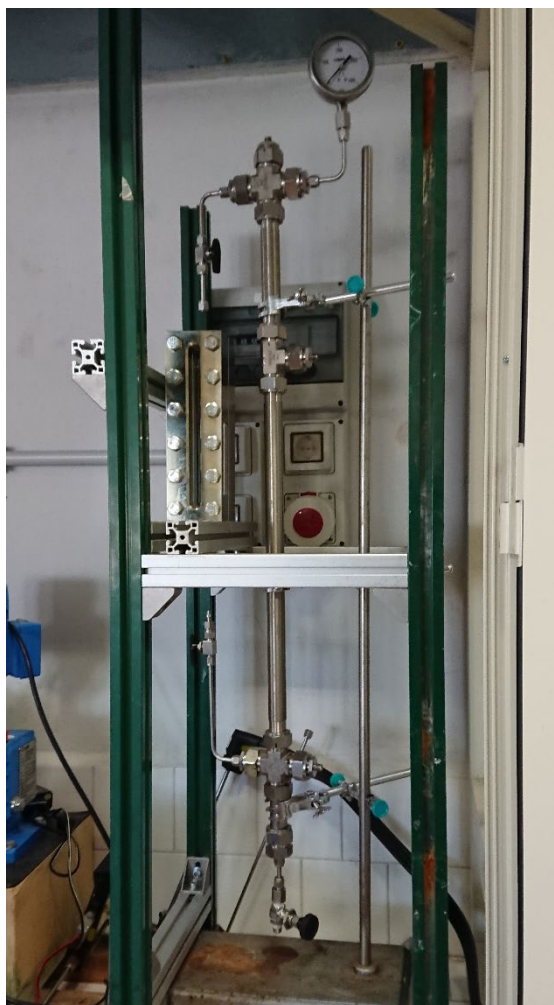
Figura 38 Separatore gas-liquido ad alta pressione
