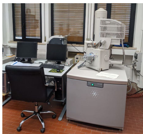
Figura 107 A sx: schema del funzionamento del SEM 6 ; a dx: foto del SEM
