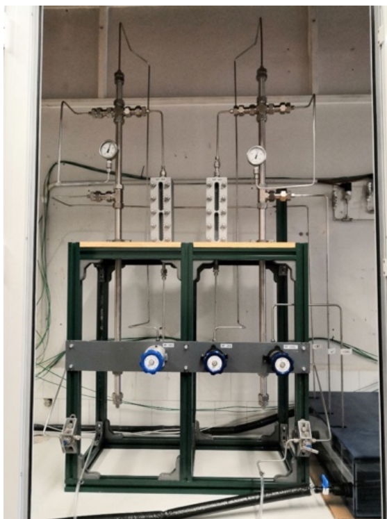
Figura 94 Separatori gas-liquido per i fluidi in uscita dal reattore
