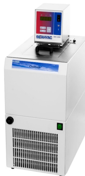
Figura 35 Sistema di raffreddamento del fluido in uscita dal reattore
