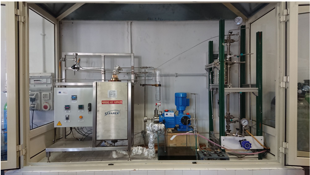
Figura 41 Configurazione v.3 dell'impianto da laboratorio per lo studio dell'ossidazione di percolato in acqua supercritica
