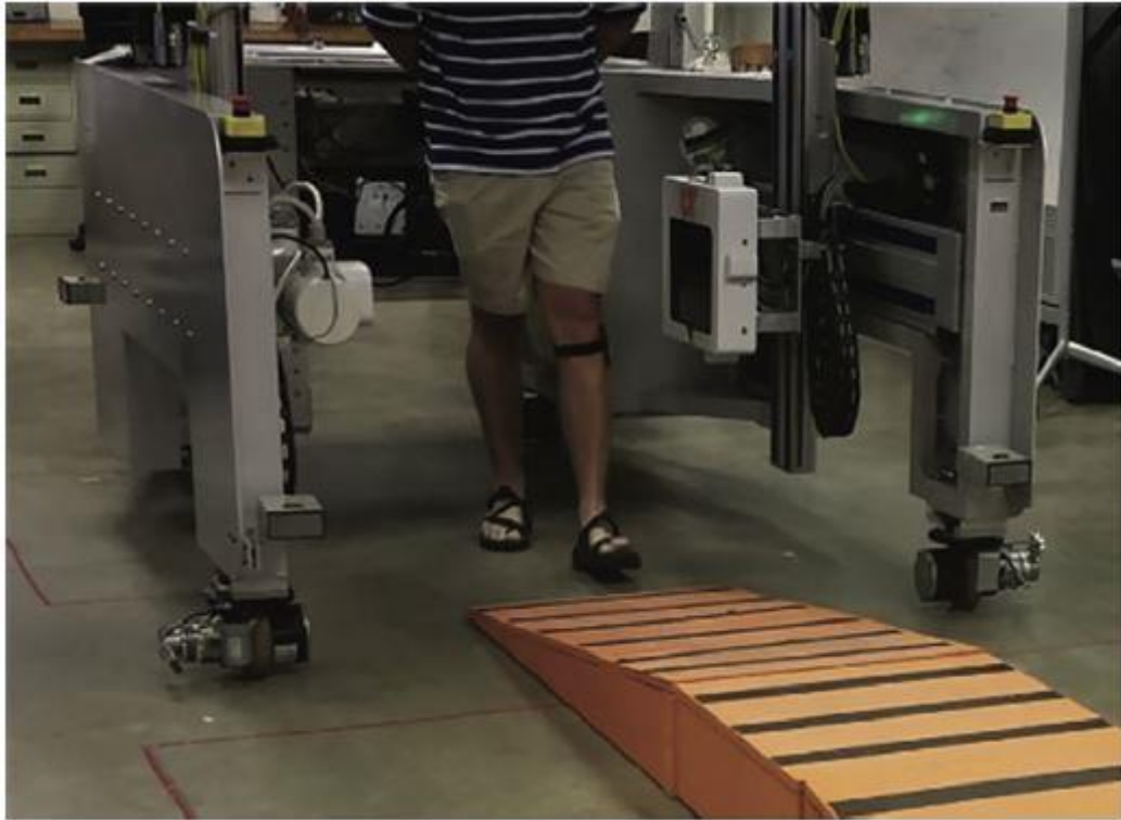
Figura 3. Configurazione utilizzata per la fluoroscopia dinamica.
