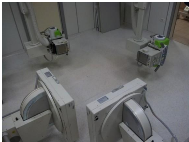
Figura 4. Configurazione utilizzata per la tecnica di radio-stereo-fotogrammetria dinamica.
