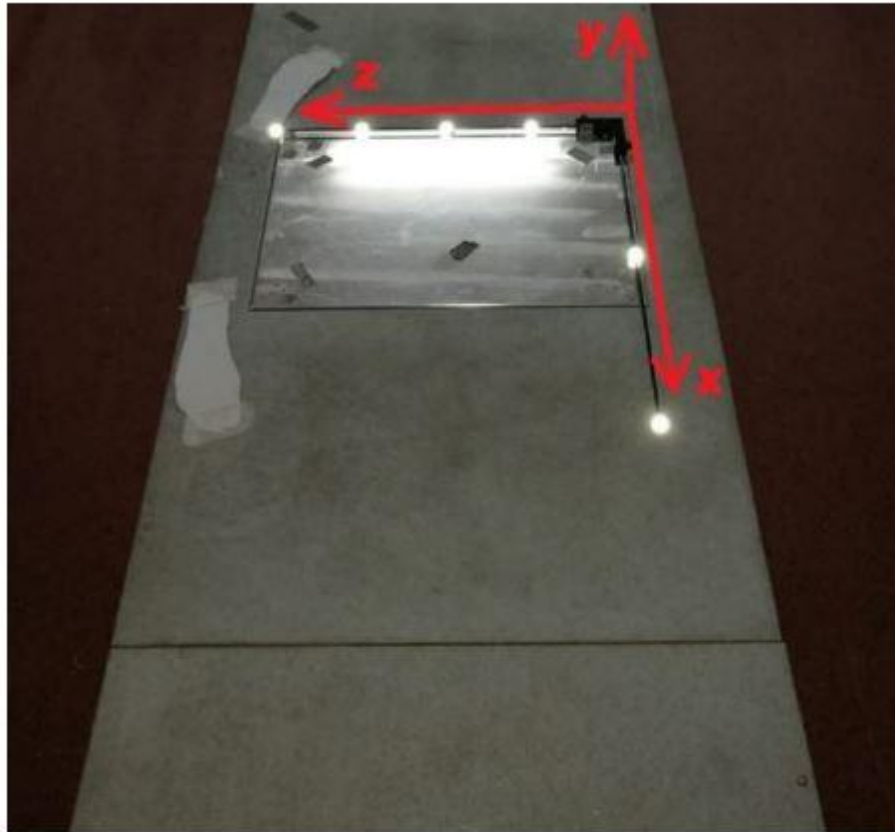
Figura 34. Sistema sperimentale per l'acquisizione dei carichi: camminatoio e pedana di forza.
