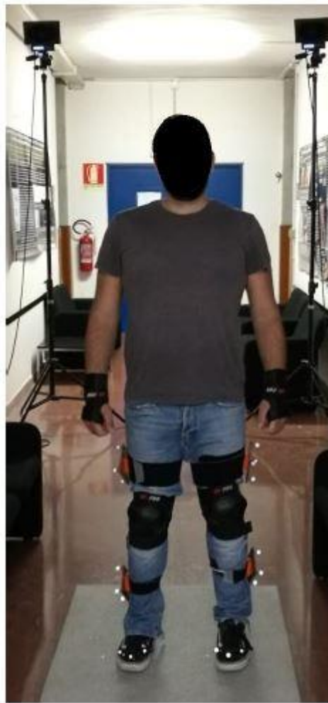
Figura 36. Soggetto equipaggiato con protezioni e markers riflettenti per l'analisi "motion capture".
