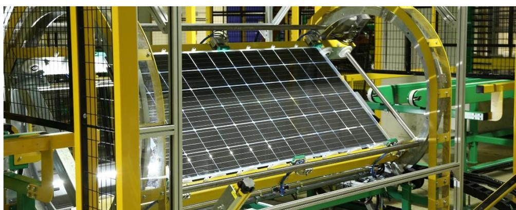
Figura 7: Modulo fotovoltaico bifacciale HJT in fase di assemblaggio. [3]
