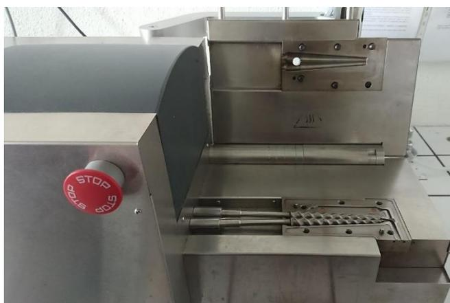
Figura A8: Interno del Mini Estrusore HAAKE MINILAB; Particolare delle viti corotanti
