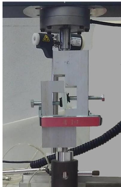
Figura A22: Tool per lo Shear Test montato su Instron 3365, UK.
