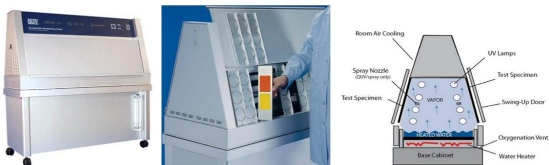
Figura A15: Foto-ossidatore Q-UV LAB per l'invecchiamento accelerato dei campioni
