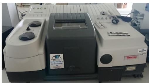
**Figura A16: spettrofotometro ad infrarossi:
