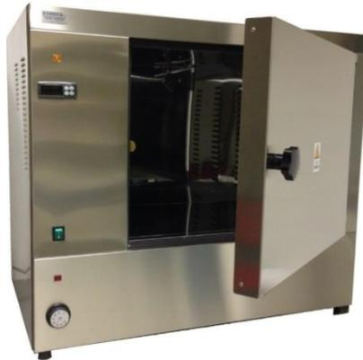
Figura A13: Stufa ventilata
