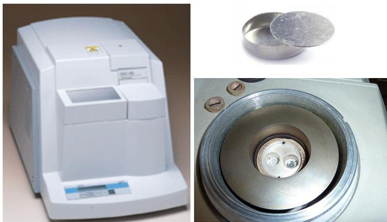
Figura A12: Calorimetro Differenziale a Scansione DSC60-Shimadzu con relativa vista dell'alloggio per i provini e porta campione.
