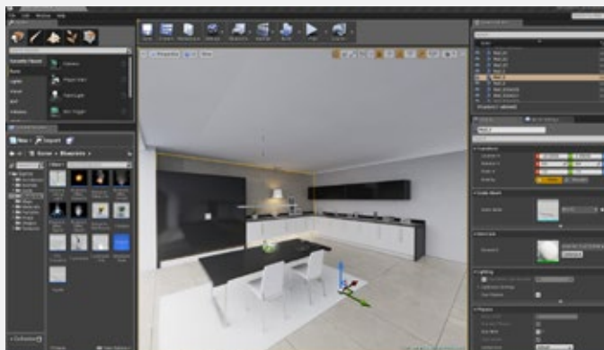
Figura 4.1.10: L'interfaccia del programma Unreal, motore grafico per videogiochi, utilizzato dagli architetti per creare modelli navigabili in realtà virtuale.
