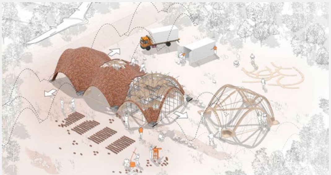
Figura 2.5.6: Schema che spiega il sistema facilitato di produzione di volte attraverso tecnologie di facile reperimento anche in paesi in via di sviluppo. (immagine Norman Foster foundation)
