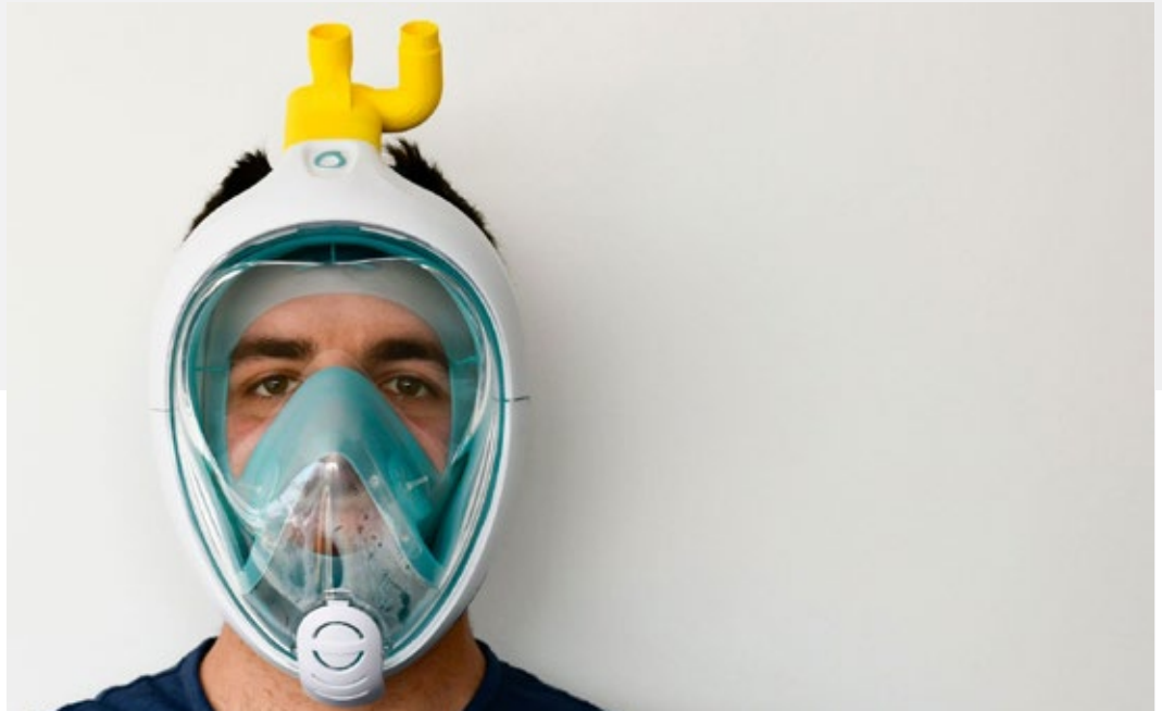
Figura 2.5.1: La valvola stampata in 3D che ha permesso di adattare delle maschere da sub al sistema dei ventilatori polmonari. (immagine Isinnova)
