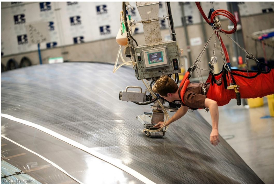
Fig. 21 - Disposizione delle fibre di carbonio in una vela.
