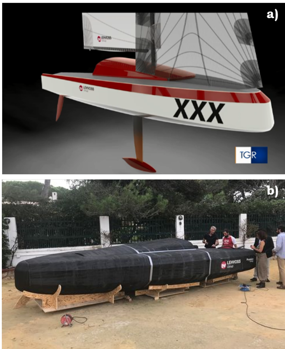
Fig. 22 - Disegno CAD della barca di Ocore (a) e presentazione del prototipo realizzato mediante stampa 3D.
