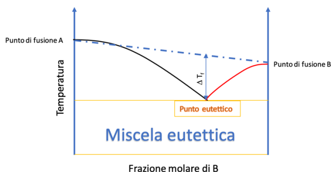
Figura 8: diagramma di fase di un Deep Eutectic Solvent.
