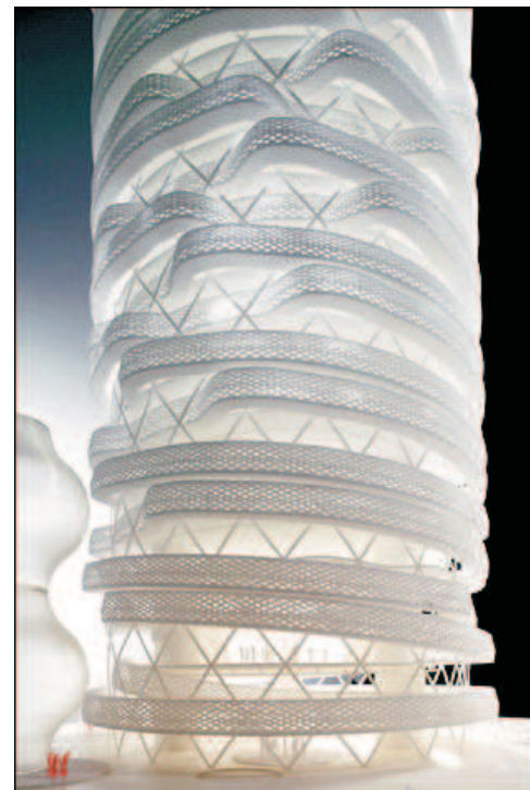
Carbon Fibre Tower progettata da Peter Testa Architects e Arup New York nel 2002. E' il prototipo di un grattacielo realizzato interamente da materiali compositi soprattutto a base di carbonio. La struttura sarà realizzata da singole fibre di carbonio "tessute" tra di loro a nido d'ape tramite appositi nanobot.
