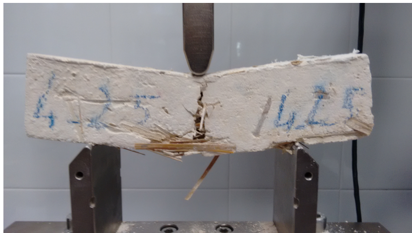
Fig. 2.9 Setup di una tipica prova di flessione a 3 punti su un provino di malta rinforzata con il 2% di fibre corte
