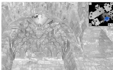
Figg. 6-8. Viste delle nuvole di punti di acune strutture a muqarnas del primo piano della Zisa di Palermo (ReCap Pro di Autodesk).
