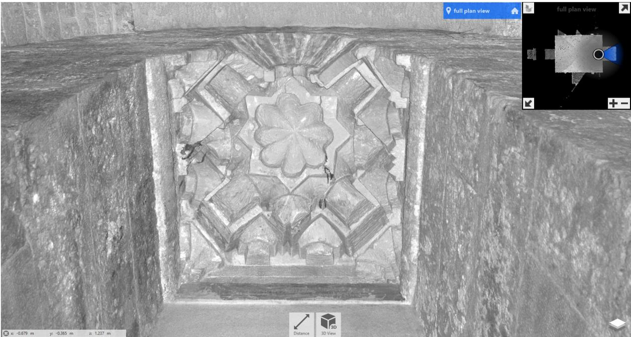
Fig. 17. Nuvola di punti della piccola nicchia a muqarnassita al piano terra della Zisa M0.4 (REVIT).
