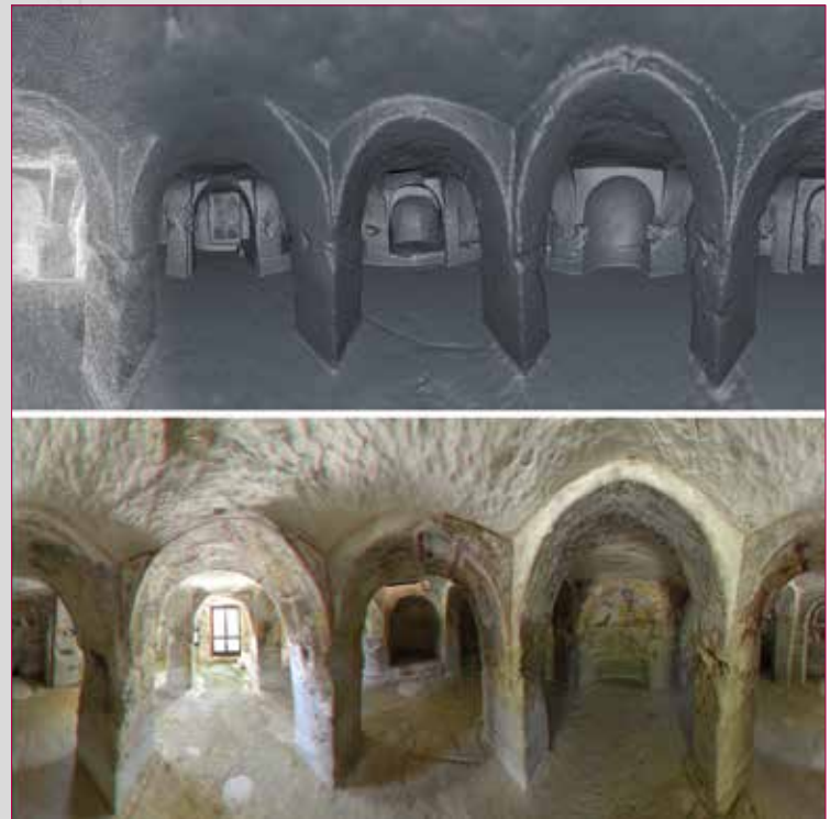
Fig. 4 - Immagini panoramiche della chiesa dei Santi Stefano a Vaste (LE): visualizzazione in shading e wireframe (sopra) e in stereoscopia (sotto).
