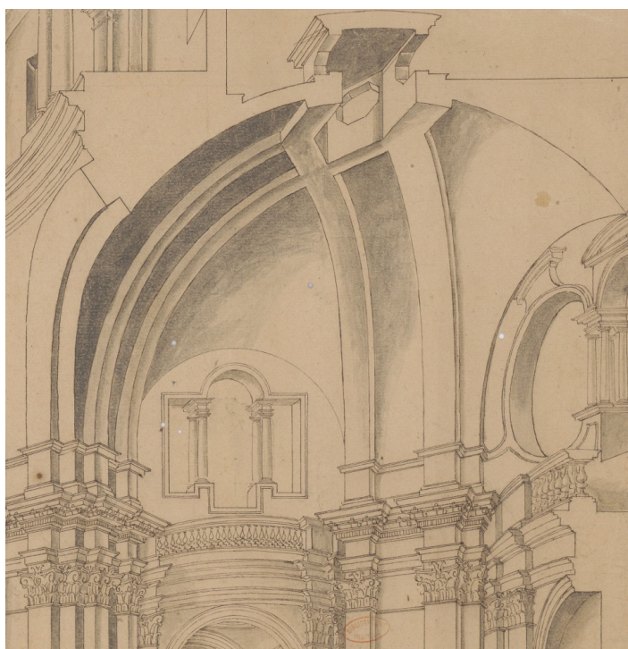
Fig. 43 G. Feuillet, sezione prospettica della chiesa di Sainte-Anne-la-Royale, dettaglio della volta a fasce
