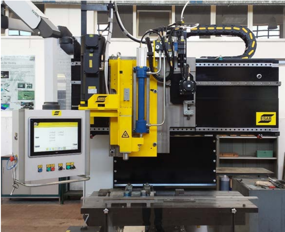
Figure 3.6. ESAB LEGIO FSW 3ST.
