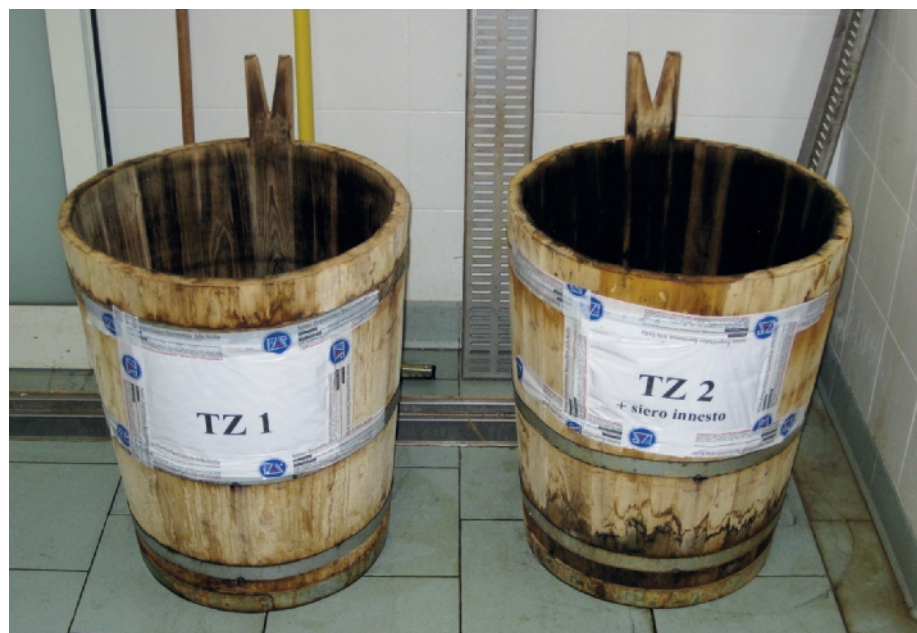
Figura 4. Attivazione batterica dei tini vergini con siero acidificato spontaneamente (controllo, TZ1) e con siero-innesto contenente ceppi di Lactococcus lactis subsp. cremoris selezionati (sperimentale, TZ2)
