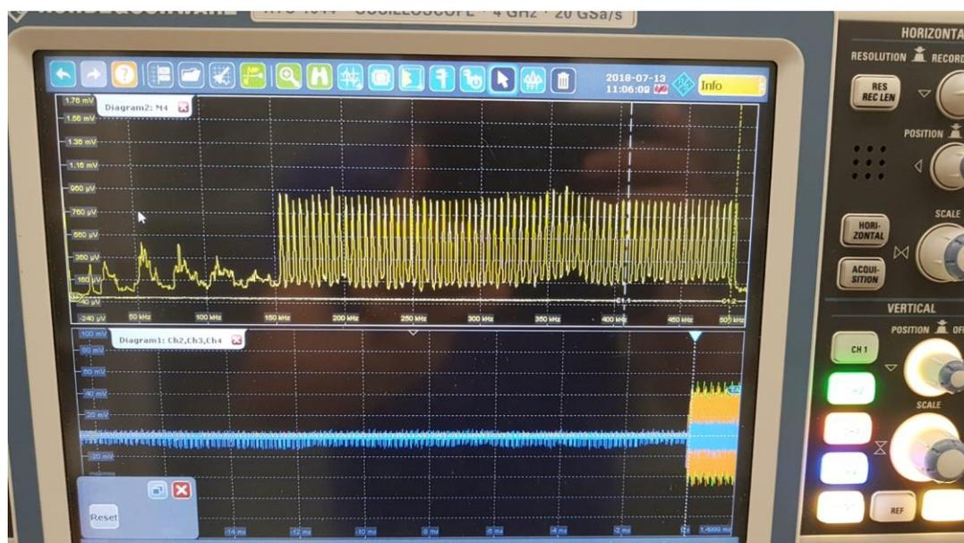
**Fig. 97** Spettro del preambolo del segnale OFDM trasmesso su tutta la banda FCC (72 sinc corrispondenti alle 72 sottoportanti)
