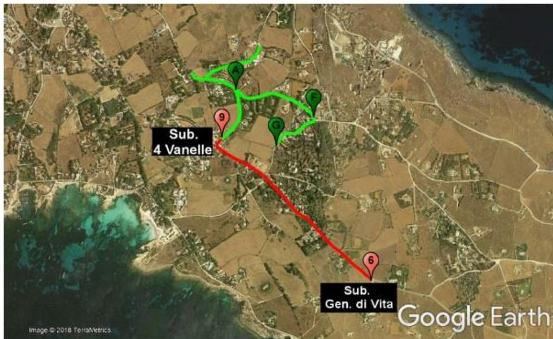
**Fig. 87 Rete MT/BT utilizzata per i test di comunicazione PLC**
