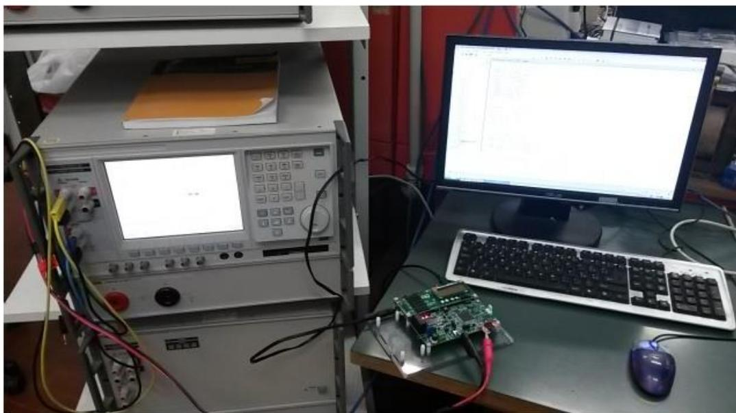
Fig. 90 Set up di misura per la verifica delle metriche di PQ dell'EVALKIT STCOMET10-1
