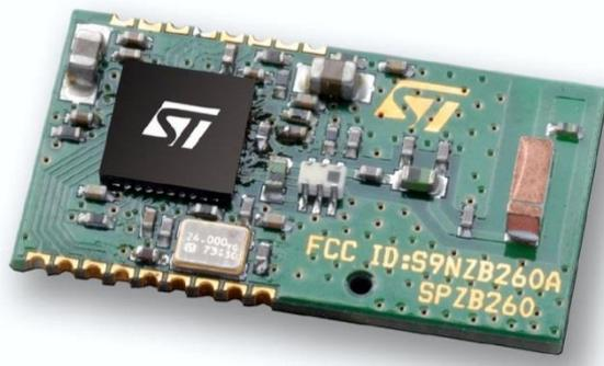
*Fig. 6 Il modulo opzionale ZigBee*
