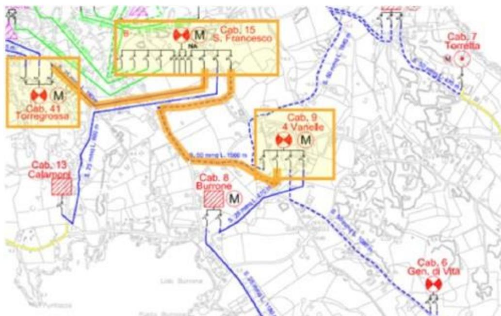
**Fig. 69** Linea MT dell'isola di Favignana che collega la cabina nodale "4 Vanelle" e la cabina nodale "Torregrossa". Tra le due cabine è presente la cabina intermedia "S. Francesco"
