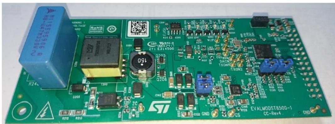
*Fig. 25 Il modulo Power Line Modem ST8500*
