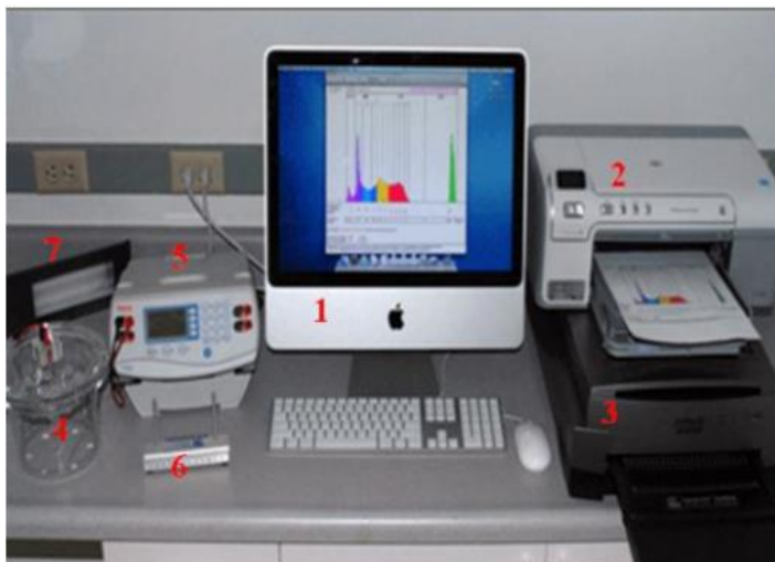
Figura 21. Lipoprint™ Quantimetrix®: 1. Computer Mac (incluso Programma Lipoware Analysis); 2. Stampante a colori; 3. Scanner digitale (raggi UV, densitometro); 4. Camera elettroforetica; 5. Alimentatore (120V/220V); 6. Rack preparazione tubi; 7. Luce di preparazione (fotopolimerizzatore). 229
