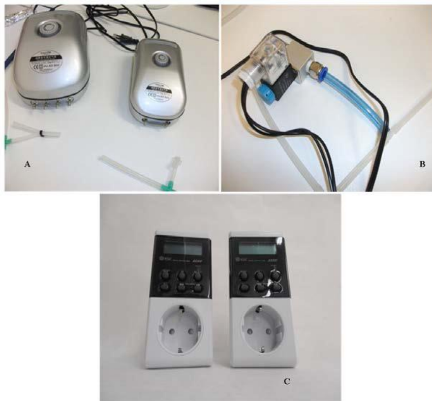
Figura 5 - A: pompe per il funzionamento del sistema; B: elettrovalvola utilizzata per favorire la fuoriuscita di aria dal sistema; C: timer utilizzati per attivare il sistema.
