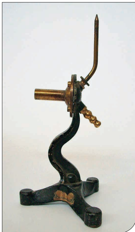
Fig. 8. Bruciatore a gas con capsula manometrica (Collezione Storica degli Strumenti di Fisica dell'Università di Palermo).
