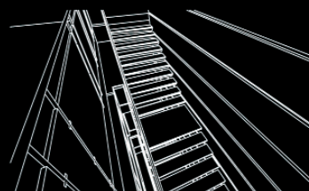
Scala con gradini a sbalzo
