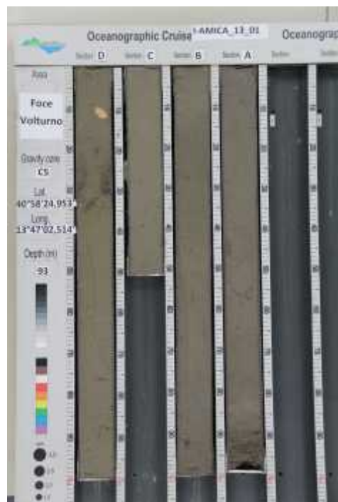
Figura 12 - Esempio di carota aperta e preparata per la fotografia, la descrizione e il campionamento.
