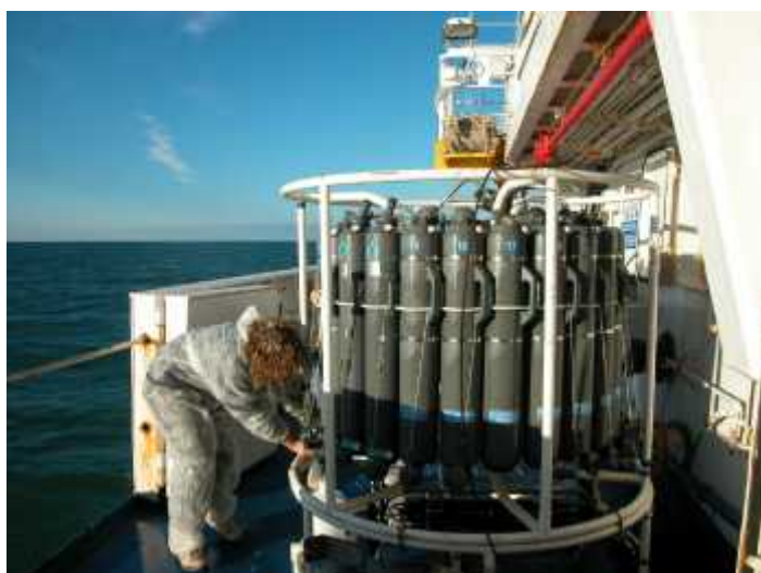
Figura 15 - Campionatore d’acqua Niskin con 24 bottiglie da 10l, installate sulla struttura della sonda multiparametrica SeaBird (SBE 911).
