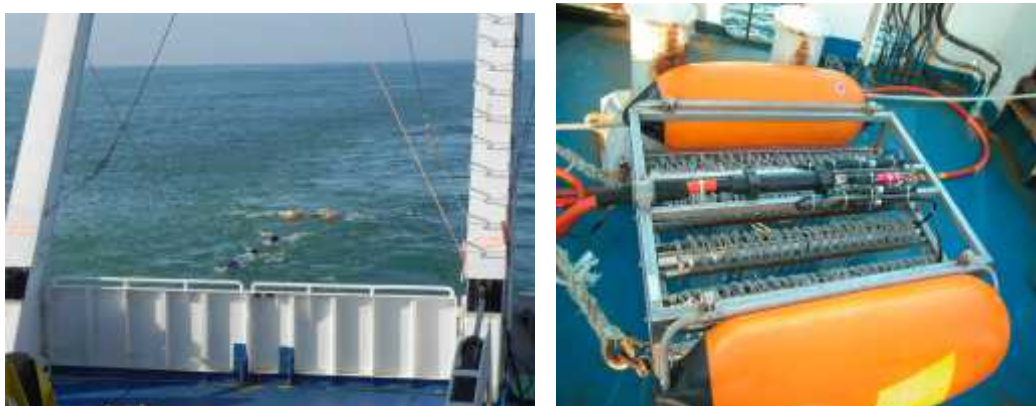
Figura 10 - Sistema di acquisizione monocanale Sparker con sorgente Multitip.
