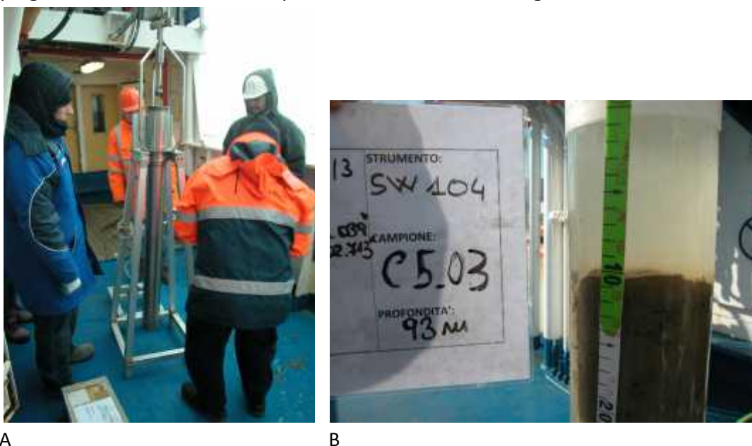
Figura 13 - (A) Carotiere SW104; (B) particolare della carota prelevata con interfaccia acqua-sedimento preservata.
