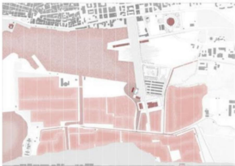
Planimetria e profilo di progetto. Il disegno complessivo prevede l'ampliamento del porto, come da piano regolatore, e lega il recupero della centrale ad altri tre edifici industriali dismessi vicini; ripensa la viabilità e il collegamento ferroviario delle banchine, e riattiva il rapporto della centrale con il mare.
