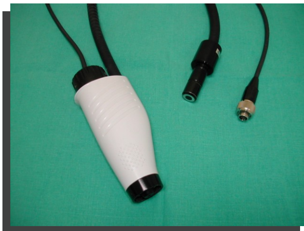
Figura 12. Particolare della sonda ottica. Dal dorso della sonda partono due cordoni: il primo, quello di calibro maggiore, è deputato all'illuminazione; il secondo è deputato alla trasmissione del segnale video.
