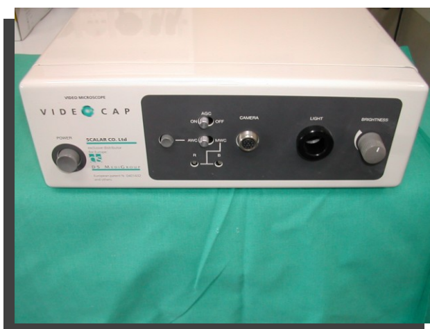
Figura 14. Corpo del capillaroscopio. Frontalmente si trovano, da sinistra verso destra, la ghiera di regolazione della luminosità (quantità di luce erogata), l'alloggiamento per il terminale luminoso della sonda, l'alloggiamento per il terminale video della sonda, le regolazioni del punto del bianco, e del contrasto dell'immagine capillaroscopica, il pulsante di accensione/spengimento.
