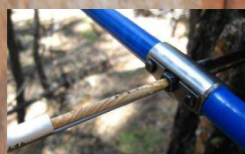
Particolare del momento di estrazione della carota.
