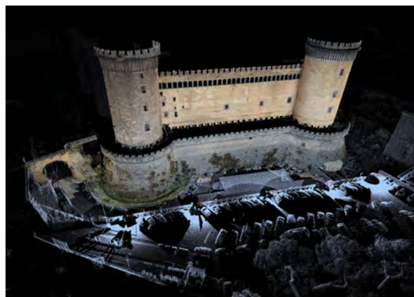
Fig. 2. Castelnuovo, Napoli. Progetto DATABENC-SNECS. Vista della nuvola dei punti rilevata. Gruppo di lavoro coordinato dal prof. Aldo Aveta, archh. R. Amore, C. Aveta, M. Salvatori, G.P. Vitelli.
