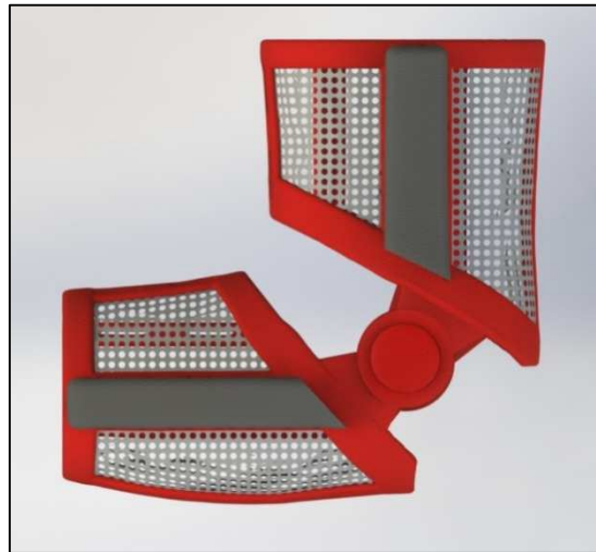
Figura 5.97– Modello CAD del secondo prototipo con cerniera
