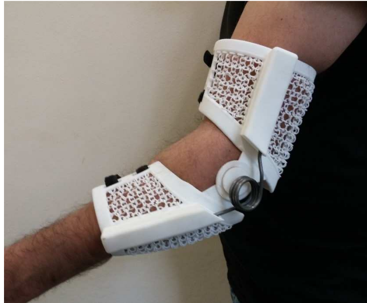
Figura 5.111 – Prototipo finale indossato dal paziente: configurazione a 50°
