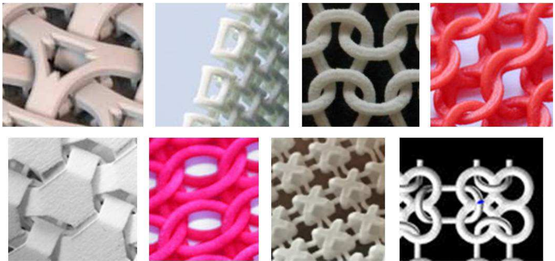
Figura 3.4 – Esempio di unità base per la modellazione di strutture AMT
