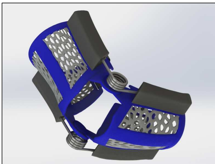
Figura 5.44 – Modello CAD dell'ortesi con tassellatura di Voronoi in Grasshopper
