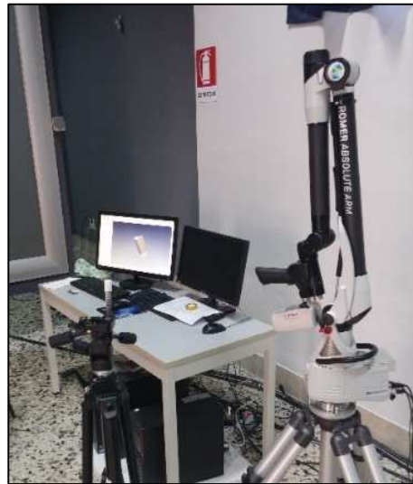
Figura 5.72 – Sistema di scansione HP-L-20.8
