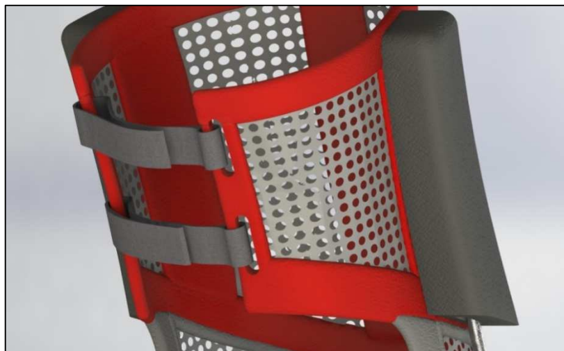
Figura 5.18 – Particolare dell'ortesi di gomito: chiusura con fascette a strappo
