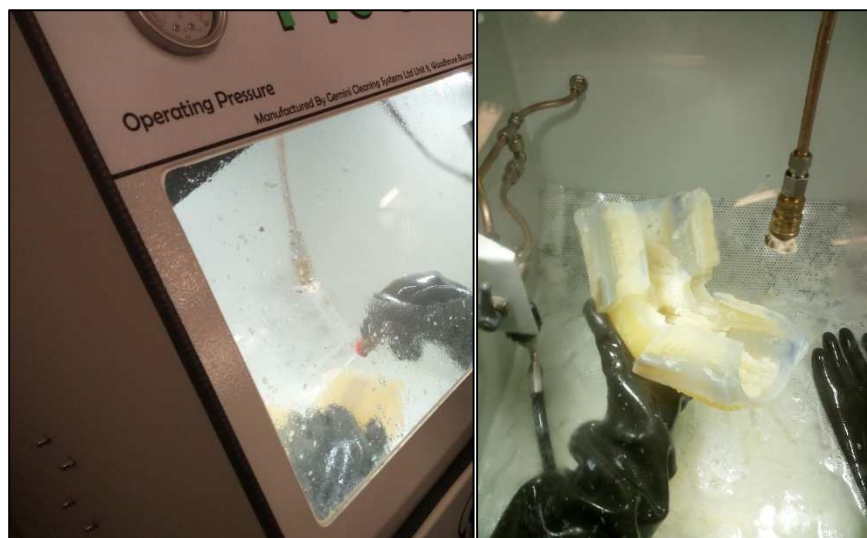
Figura 5.90 – Fasi della pulizia dal materiale di supporto
