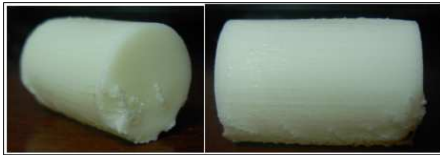
Figura 5.71– Campioni cilindrici ottenuti con direzione di slicing lungo l'asse x
