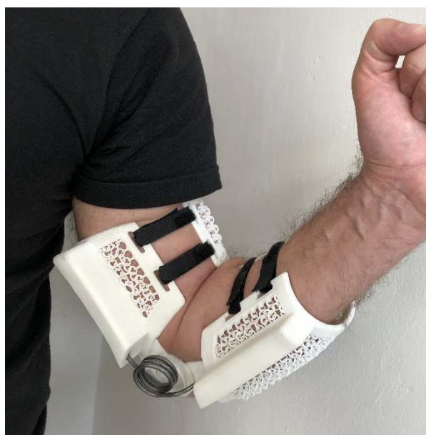
Figura 5.110 – Prototipo finale indossato dal paziente: configurazione a 110°
