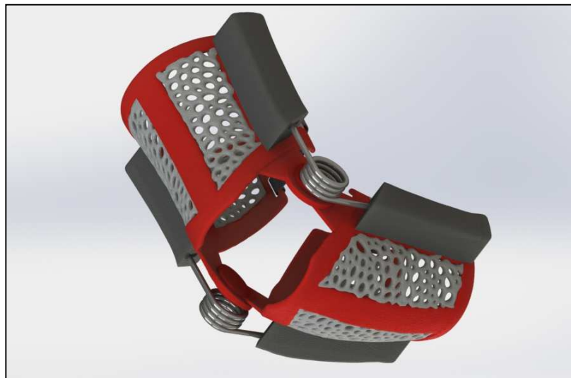
Figura 5.26 – Modello CAD dell'ortesi con tassellatura di Voronoi in Meshmixer
