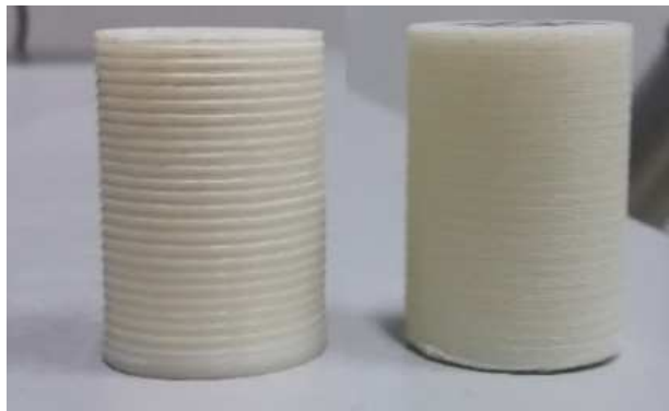
Figura 5.70 – Prototipi stampati con valori di spessore dello strato di 0,2 mm (a sinistra) e 0,05 mm (a destra)
