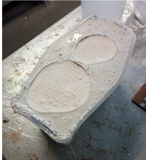
Figura 5.6 – Esecuzione del calco del braccio
