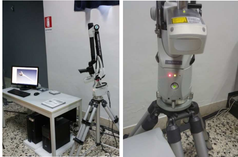
Figura 1.6 – Sistema di scansione HP-L-20.8
