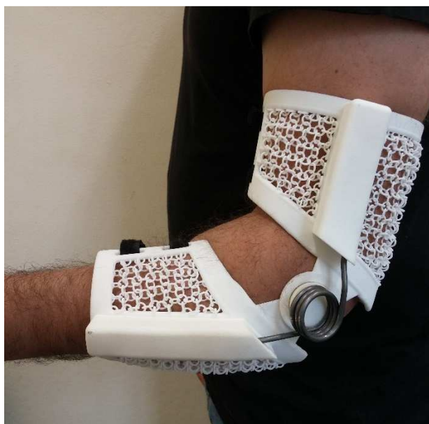
Figura 5.109 – Prototipo finale indossato dal paziente: configurazione a 90°
