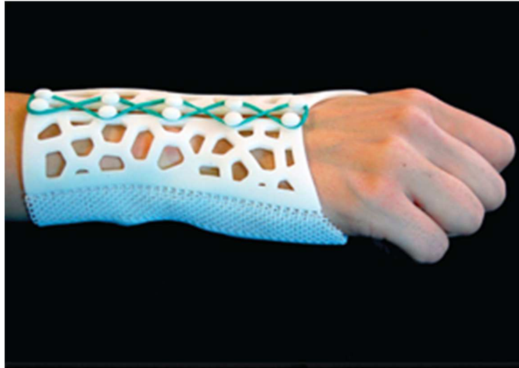
Figura 3.8 – Esempio di applicazione di AMT ad un ortesi per il polso
