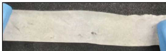
Figura 1.14 - Esempio di membrana porosa di fibre elettrofilate di PCL lunga circa 8 cm.
