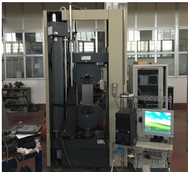
Figura 4.11 – Macchina Zwick/Roell da 600 kN.
