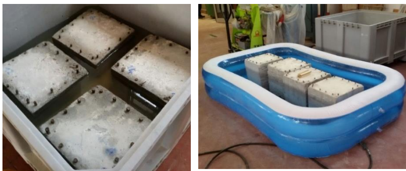
Figura 4.3 – Immersione dei provini nella soluzione acqua + cloruro di sodio.
