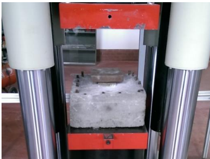
Figura 5.1 – Piastra in acciaio utilizzata per la ripartizione del carico.
