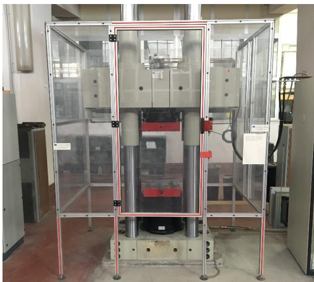
Figura 4.10 – Macchina Zwick/Roell & Toni Technik da 4000 kN.
