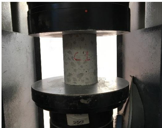
Figura 4.15 – Prova di compressione su carota C1.
