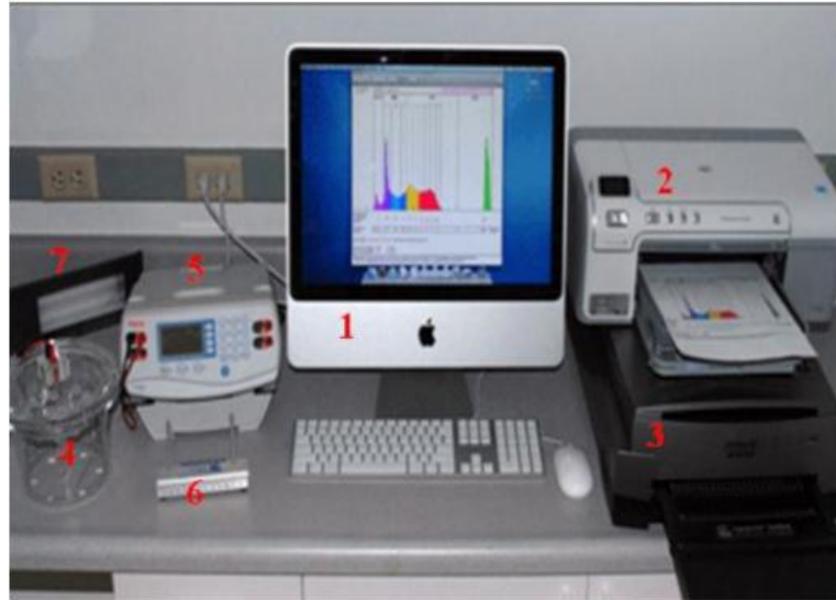
Figura 23. Lipoprint™ Quantimetrix®: 1. Computer Mac (incluso Programma Lipoware Analysis); 2. Stampante a colori; 3. Scanner digitale (raggi UV, densitometro); 4. Camera elettroforetica; 5. Alimentatore (120V/220V); 6. Rack preparazione tubi; 7. Luce di preparazione (fotopolimerizzatore) 324 .
