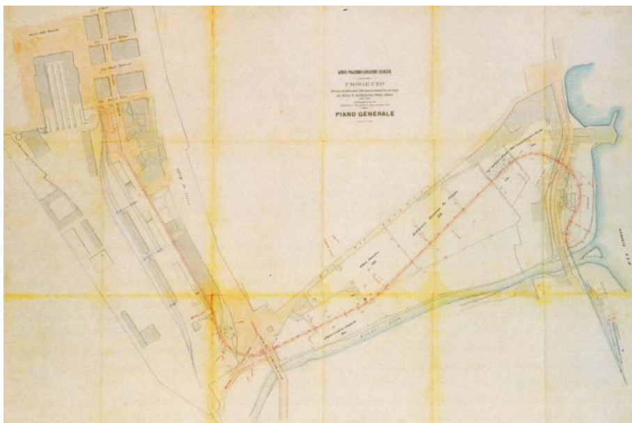
Fig. 18 a Tavola generale del progetto (non realizzato) per il tracciato ferroviario di collegamento tra la stazione di testa della ferrovia a scartamento ridotto Palermo-Corleone e la stazione Centrale
