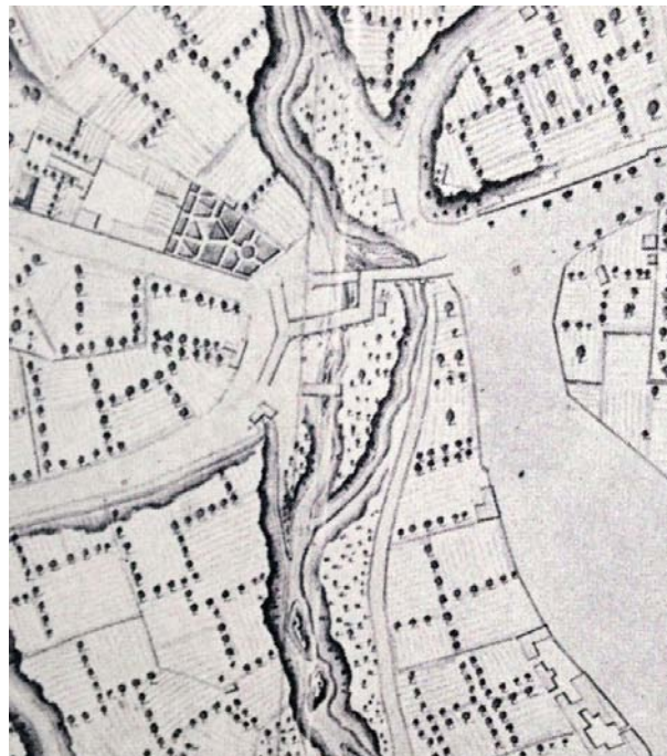
Fig. 4 La pianta dei primi anni del secolo XIX mostra la presenza del ponticello del marchese Natale, a monte del ponte normanno, che veniva così a costituire un'alternativa per un percorso più comodo e rapido. Sono ancora rappresentati un paio di ponti (in legno) a valle del principale
