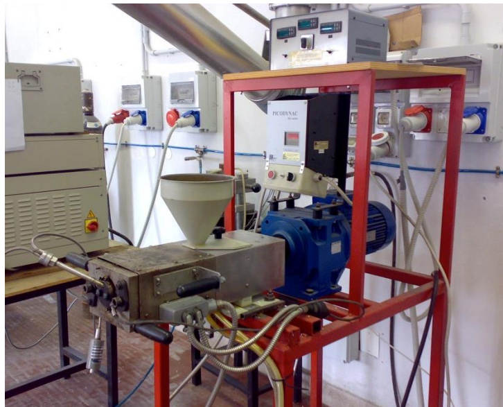
Figura 16. Estrusore bivate controrotante compounder Brabender.
