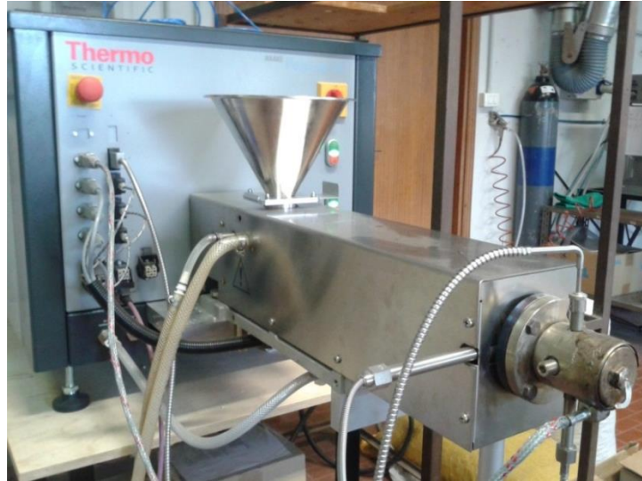
Figura 20. Estrusore monovite Thermo Scientific utilizzato per la rilavorazione dei materiali.
