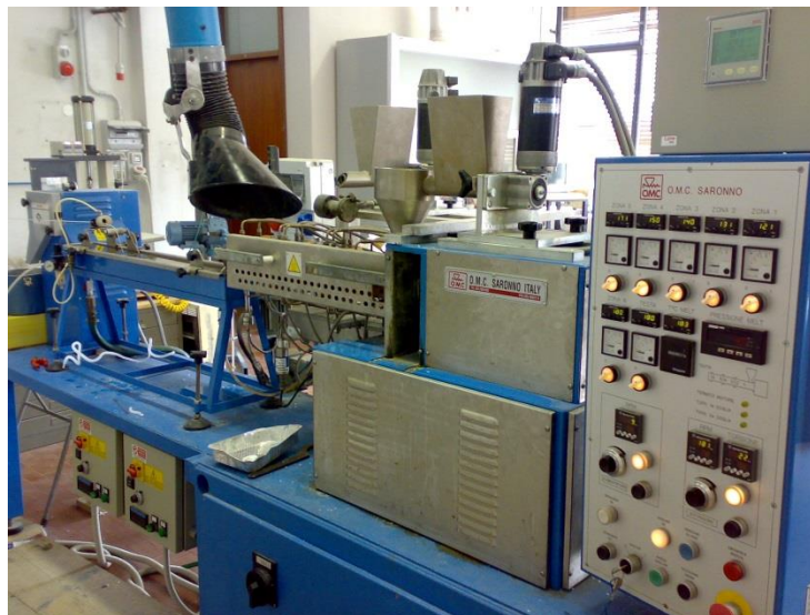
Figura 17. Estrusore bivate corotante utilizzato per la preparazione di alcuni dei nanocompositi.
