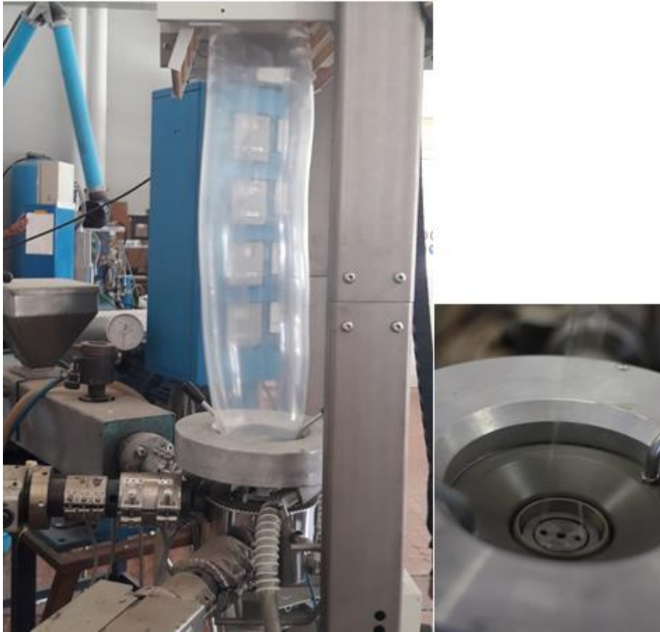
Figura 18. A sinistra: estrusori monovite Brabender con unità di filmatura. A destra: testa per il soffiaggio con anello per il raffreddamento.
