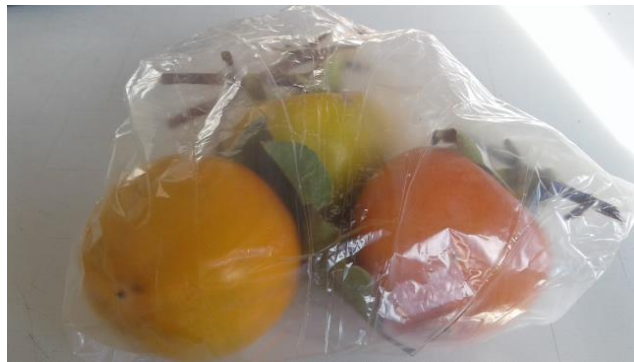
Figura 43. Foto di loti avvolti con il film PLA/MaterBi prodotto. È possibile osservare che la trasparenza del film bistrato permette l'ispezione dei frutti all'interno.
