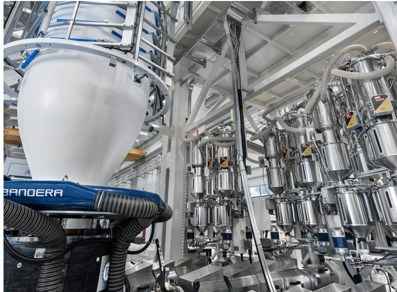
Figura 7. Filatura in bolla industriale di un film multistrato. È possibile osservare come i fusi polimerici arrivino separatamente (parte della destra inferiore della foto) alla testa di coestrusione.
