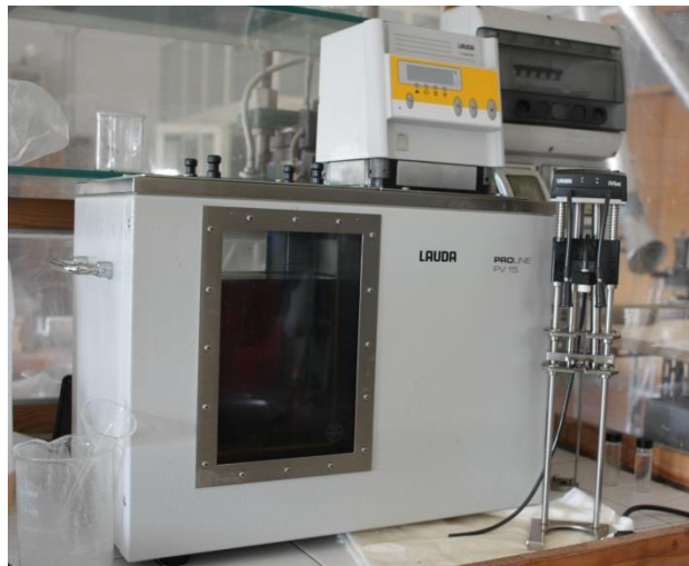
Figura 23. Viscosimetro a capillare iVisc LMV 830 Lauda usato per le misure di viscosità intrinseca.
