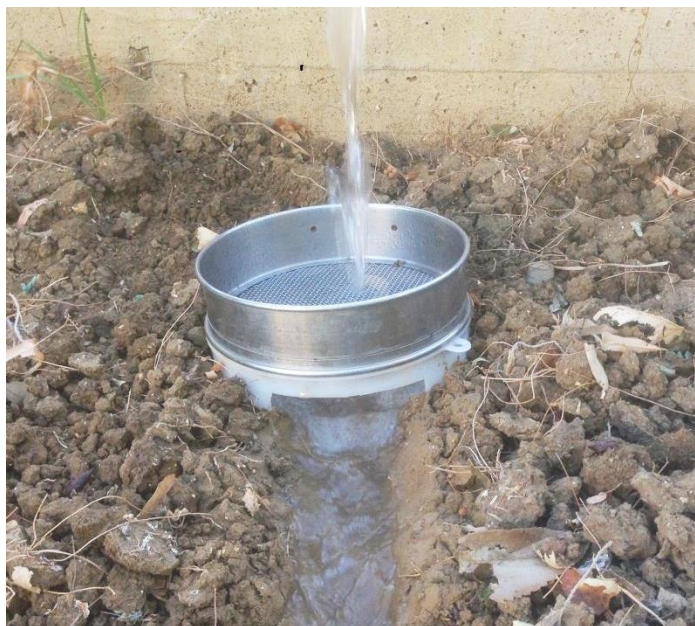
Fig. 12 - Dispositivo per l'immissione della corrente nel rill
