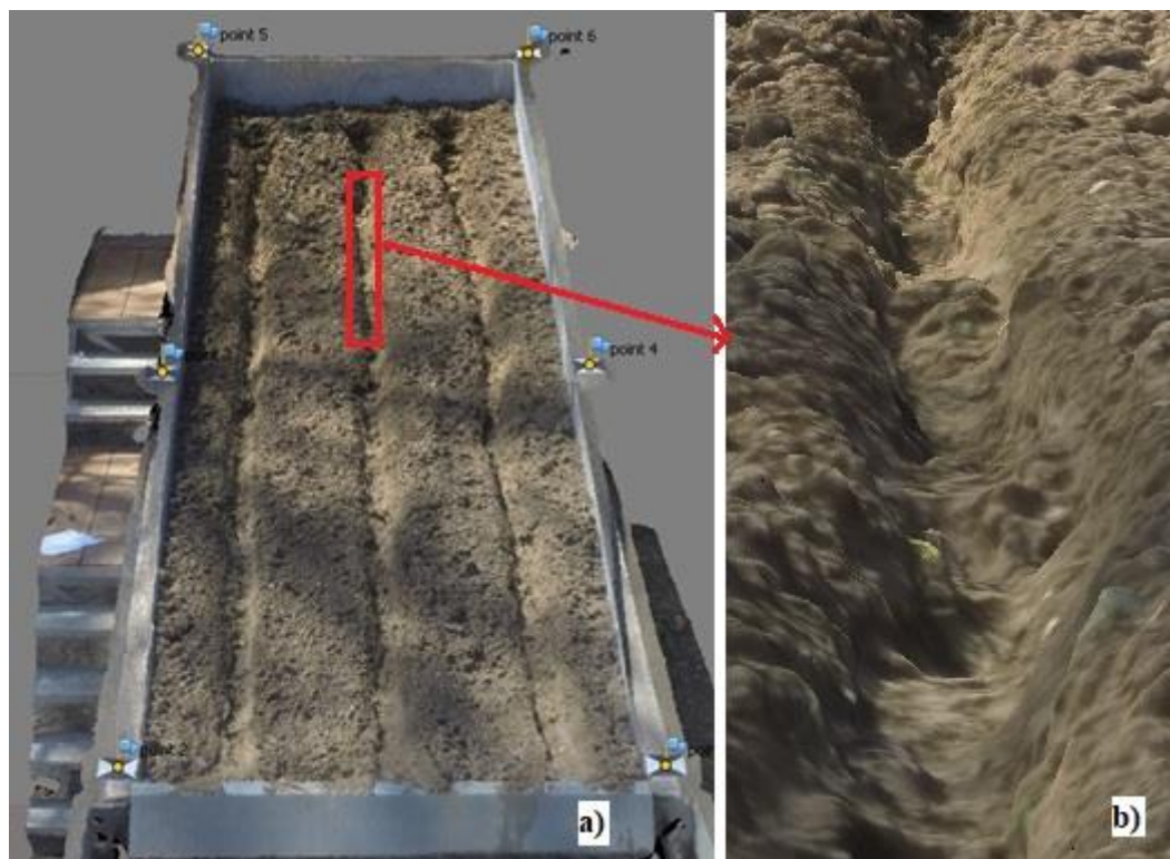
Fig. 10 - Modello 3D della parcella sperimentale ed individuazione a video dei GCP (a) e vista 3D di una porzione di rill
