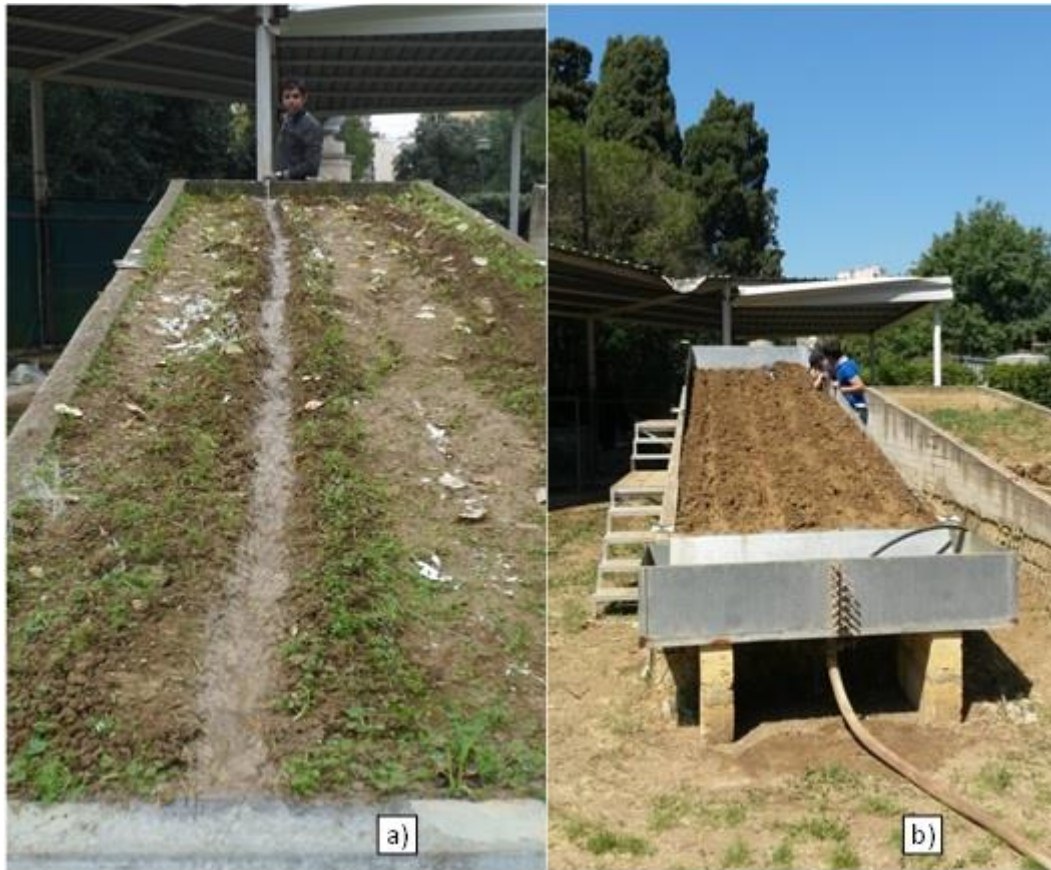
Fig. 9 - Modellamento dei solchi con una corrente idrica limpida (a) e vista dei solchi incisi nella parcella sperimentale (b)
