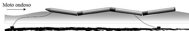
Figura 1.4. Schema del dispositivo ad energia d'onda Pelamis, in vista laterale. Il movimento delle cerniere produce l'energia idraulica per alimentare i generatori elettrici. Il dispositivo è liberamente ormeggiato sul fondo con delle funi
