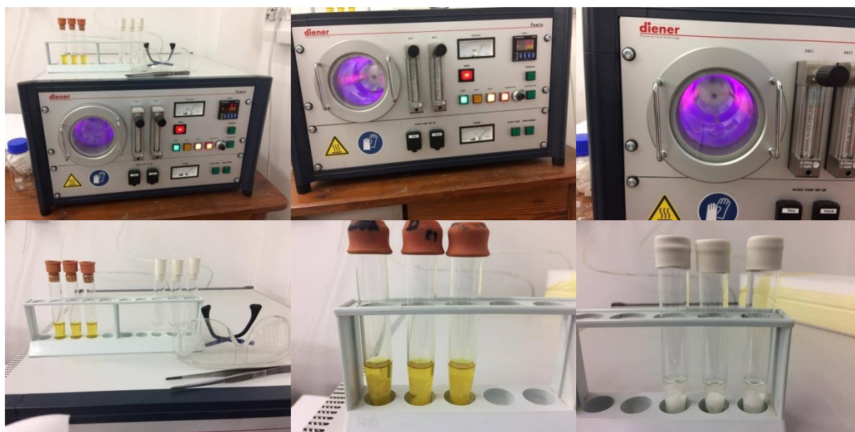
Figura 78. Attivazione del PBS con plasma di N 2 e successiva reazione tra lo scaffold attivato al plasma ed INU, PHEA ed EPA previamente attivati
