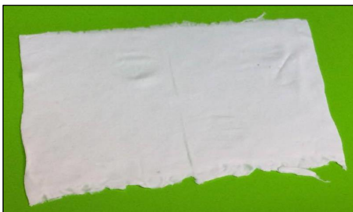
Figura 76. Fotografia degli scaffold di PBS ottenuti mediante elettrospinning
