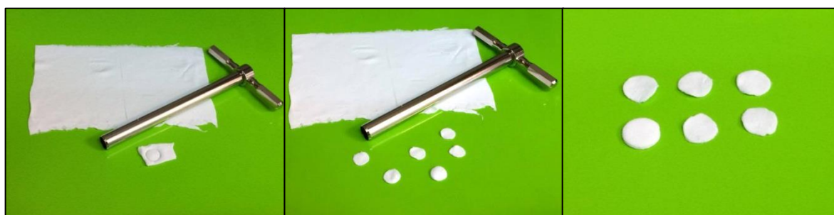
Figura 92. Ottenimento dei dischetti di scaffold con l'ausilio di un cutter
