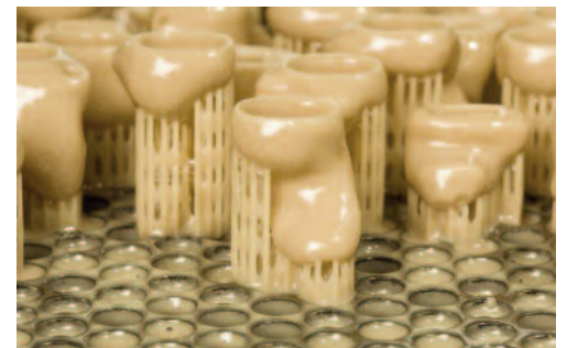
Figg. 17-19 - Fasi del processo di stampa stereolitografica di alcuni auricolari prodotti dalla azienda danese Windex (dal sito www.disruptiveinnovation.se/?tag=stereolithography , 2016).
