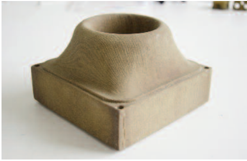
Fig. 36 - Wood-Block è un esempio di materiale stampato in 3D utilizzando un impasto a base di rifiuti agricoli riciclati; esso riproduce le venature del legno naturale e si caratterizza per una leggera traslucenza (© Giannini, 2016).
