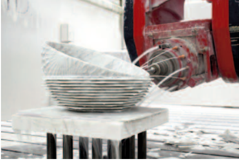
Fig. 13 - Un centrotavola in marmo prodotto da ARC, lavorato con macchina a controllo numerico (CNC) a 5 assi (© Lapidia, Erosion Collection 2017).
