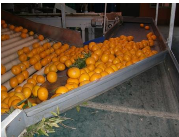
Fig. 9- Secondo nastro trasportatore con barra convogliatrice
