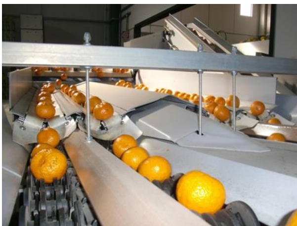
Fig. 16 - Nastri divergenti e rulli di selezione
