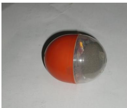
Fig. 40 - Sensore posto all'interno di una sfera di plastica durante l'esecuzione delle prove
