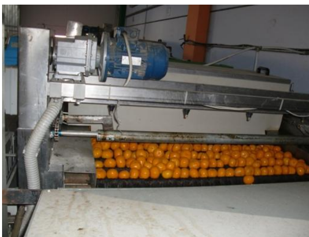
Fig. 12 - Particolare della ceratrice. Passaggio frutti su spazzole
