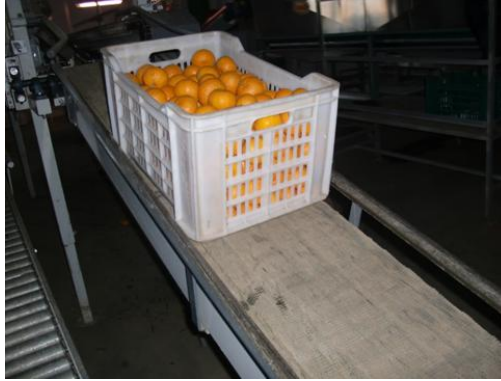
Fig. 6 - Carico cassette su nastro trasportatore
