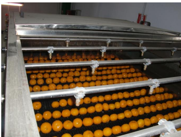
Fig. 11 - Spazzolatrice, fase di lavaggio frutti
