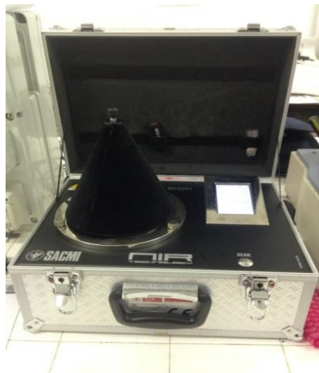
Fig. 30 Spettroscopio vis / NIR con cono scuro durante la lettura
